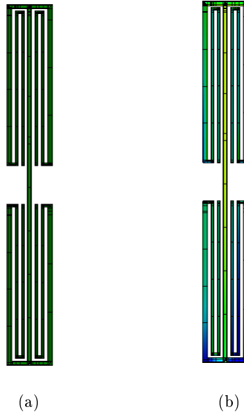
Obrázek 3.12: Kapacitně zatížený dipól (Varianta 3), struktura (a) proudové rozložení v rezonanci (b).
