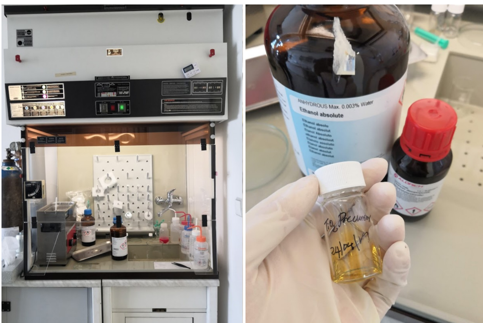
Obrázek 3.6: Filtrační digestoř Captair Toxicap v laboratoři Centra pokročilé fotovoltaiky (CAP), Katedře elektrotechnologie, FEL ČVUT v Praze. Roztok pro nanesení kompaktní vrstvy oxidu titaničitého \text{TiO}_2 pomocí sprejové pyrolýzy.
