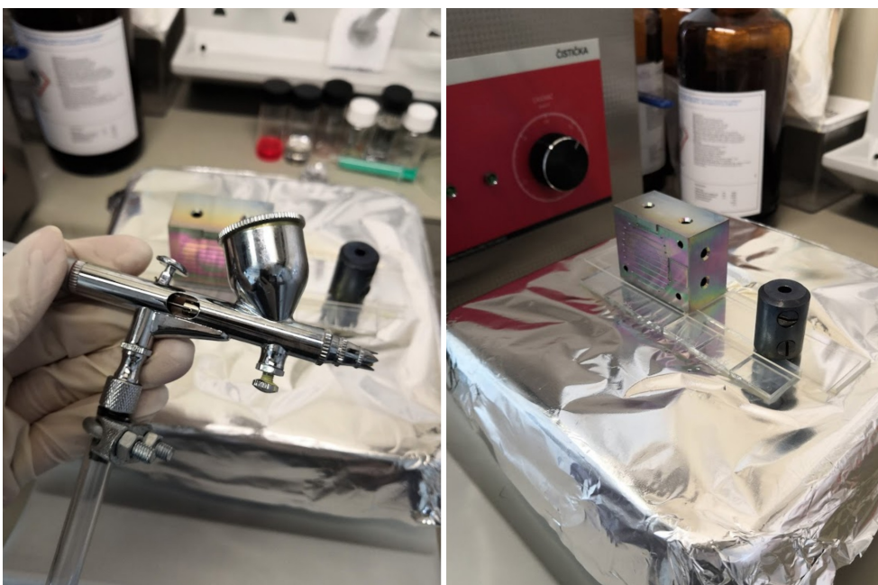
Obrázek 3.6: Filtrační digestoř Captair Toxicap v laboratoři Centra pokročilé fotovoltaiky (CAP), Katedře elektrotechnologie, FEL ČVUT v Praze. Roztok pro nanesení kompaktní vrstvy oxidu titaničitého \text{TiO}_2 pomocí sprejové pyrolýzy.
