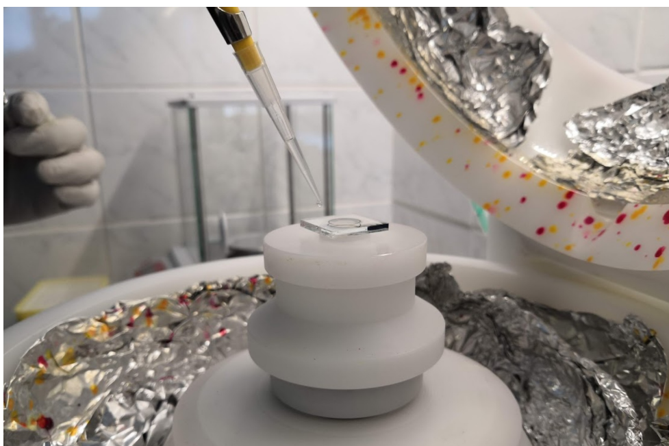
Obrázek 3.8: Nanesení mezoporézní vrstvy oxidu titaničitého \text{TiO}_2 pomocí spin-coateru .
