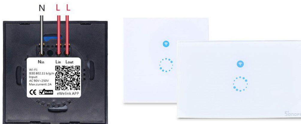
Obrázek 2.5: Sonoff Touch zapojení (vlevo), Sonoff Touch (vpravo)[52]
