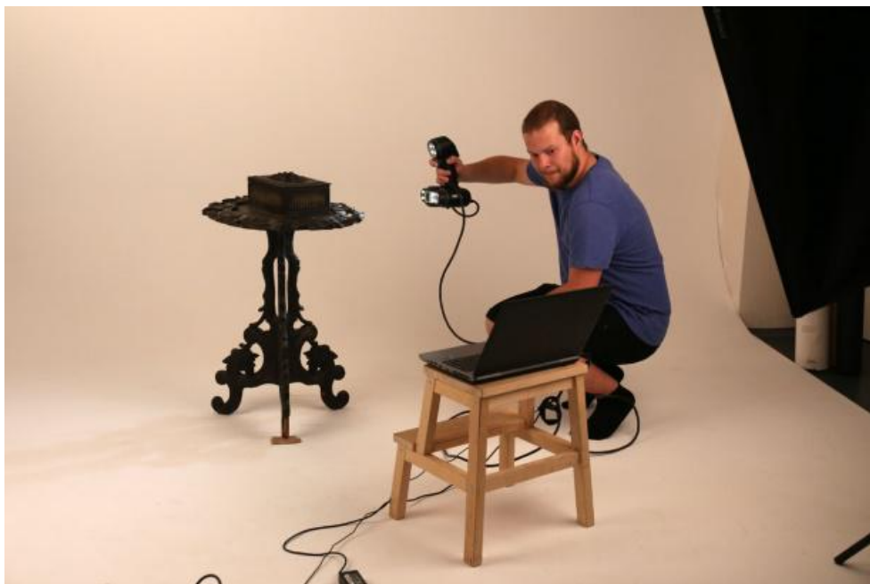
Obrázek 4.2: Snímání sbírkového předmětu pomocí ručního 3D skeneru
