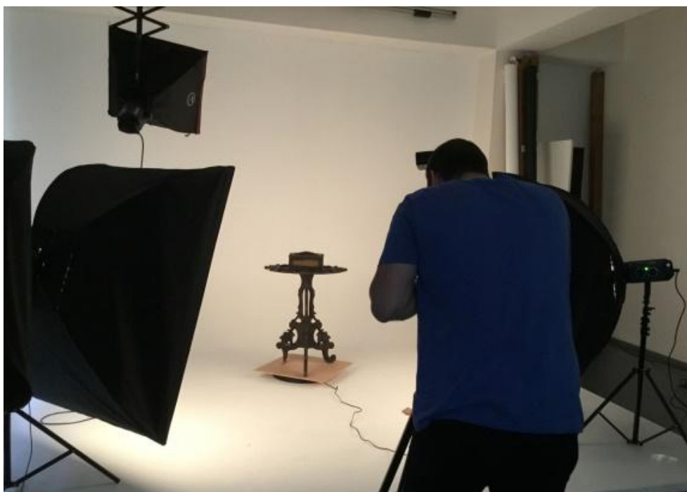
Obrázek 4.1: Snímání sbírkového předmětu pomocí fotogrammetrie
