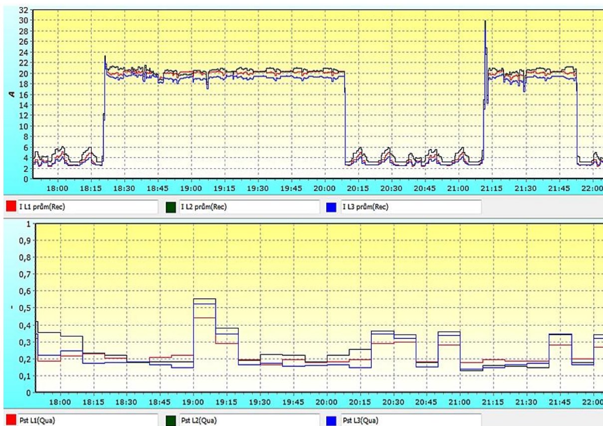
Obr. 7-8: Scénář 3 - Detail proudu a krátkodobého flikru v jednotlivých fázích
