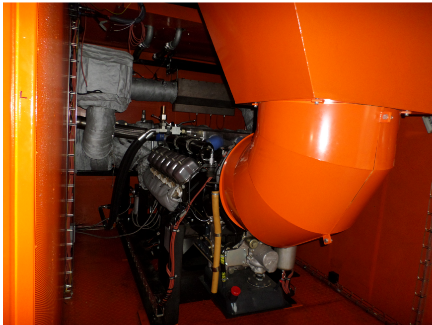
Obrázek 3.1: Dvanáctiválcový přepínaný vznětový motor TATRA T3-930-50
