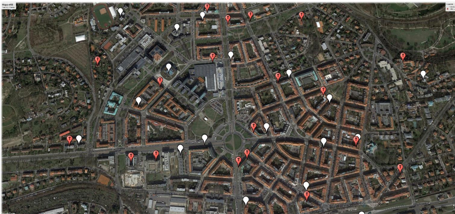
Obrázek 4.5.6: Databáze z obrázku 4.5.5, vykresleny na mapovém podkladu programu Google Earth. Bílé značky označují stanice operátora Vodafone, červeně jsou vyznačeny stanice operátora T-Mobile.
