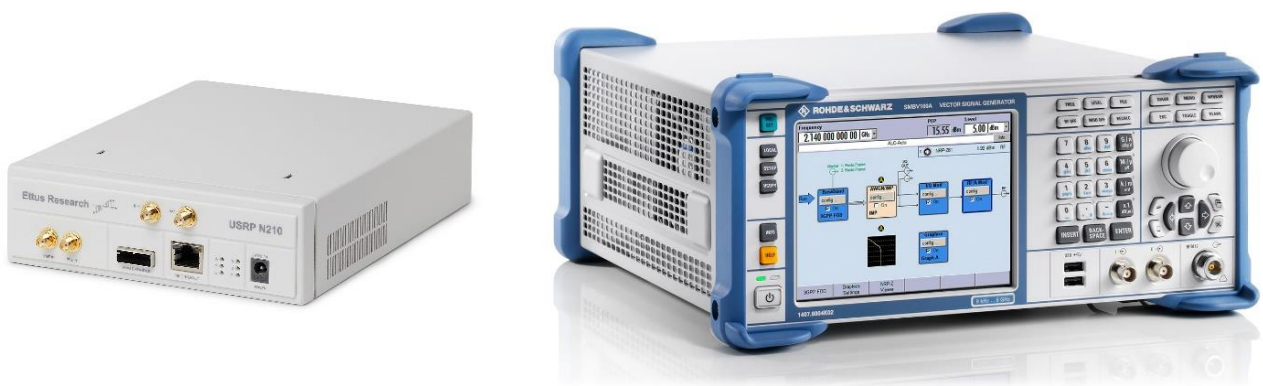
Obrázek 4.1.1: Vlevo přijímač N210 [27], vpravo generátor Rohde & Schwarz SMBV100A [39]
