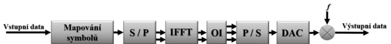
Obrázek 3.1.4: Blokové schéma vysílače OFDM (bloky S/P, resp. P/S označují sériově paralelní převody, DAC číslicově analogový převodník, a f nosný kmitočet)
