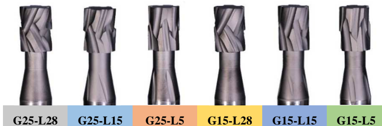
obr. 11. Prototypy CVD-D nástrojů druhé generace.
