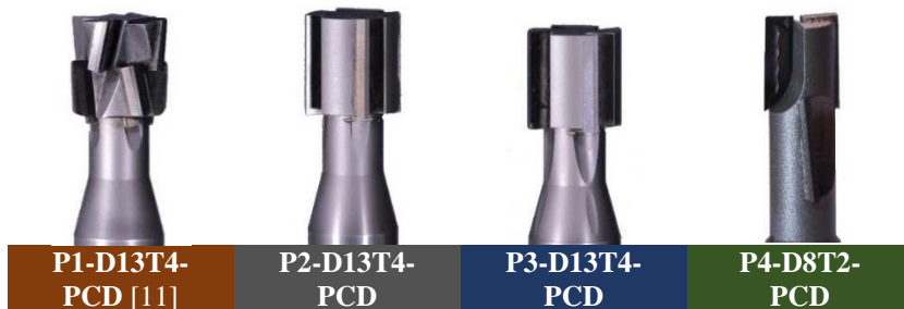
obr. 9. Prototypy PCD fréz druhé generace.
