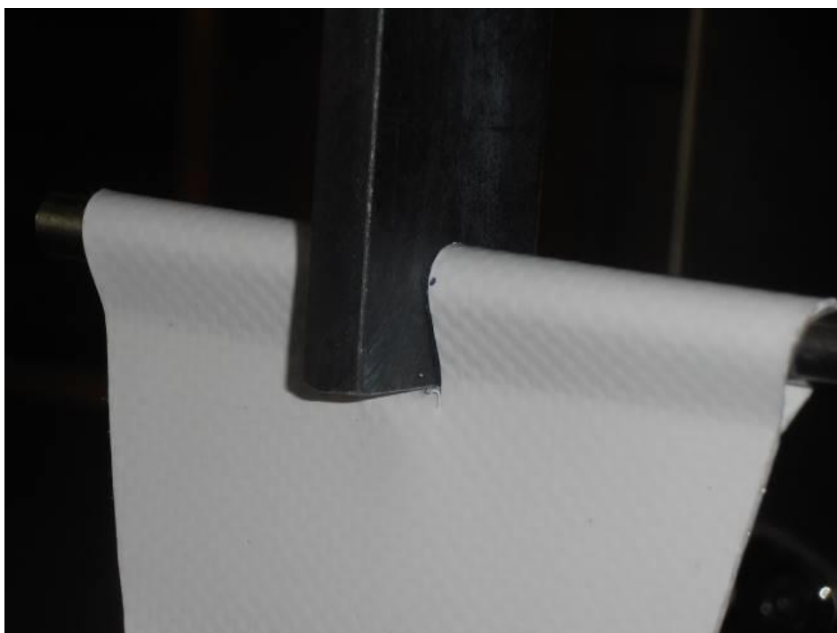
Obr. 20: Detail uchycení vzorku k přístroji [45]
