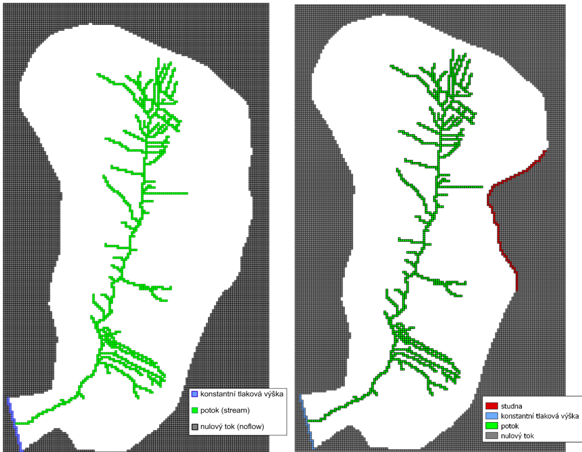
Obr. 8.32 - buňky modelu s definovanými okrajovými podmínkami, vlevo hladina napjatá, vpravo volná hladina v přívodní vrstvě
