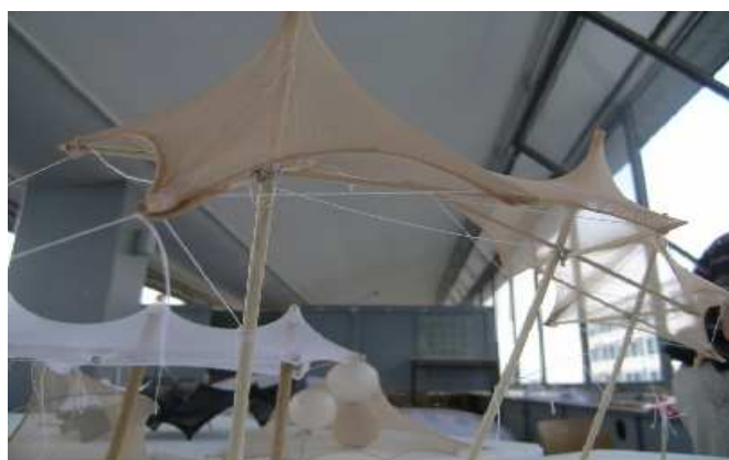
Obr. 15. Síťovaný model membránové konstrukce [9]
