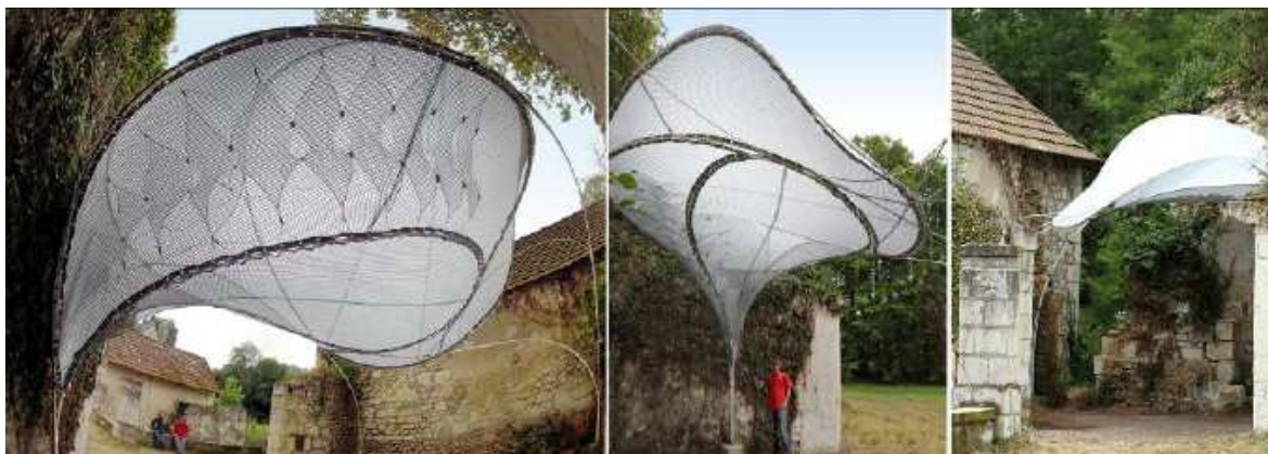
Obr. 18. Experimentální model ohybově aktivní konstrukce Hybrid M1[42]
