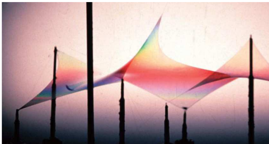
Obr. 14. Mýdlový model bodově podepřené membrány [41]
