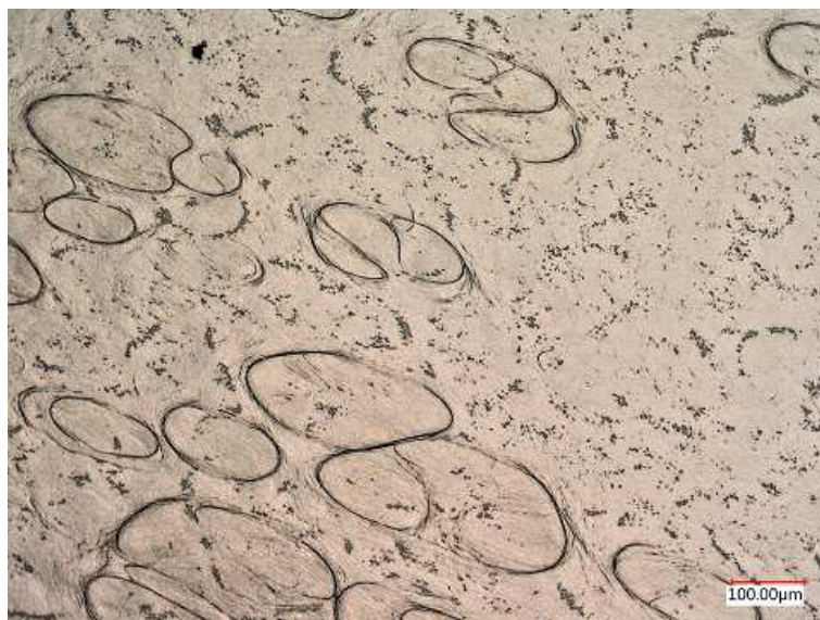
Obrázek 1.5: Struktura povrchu nanesené kovové vrstvy na polypropylénové folii
