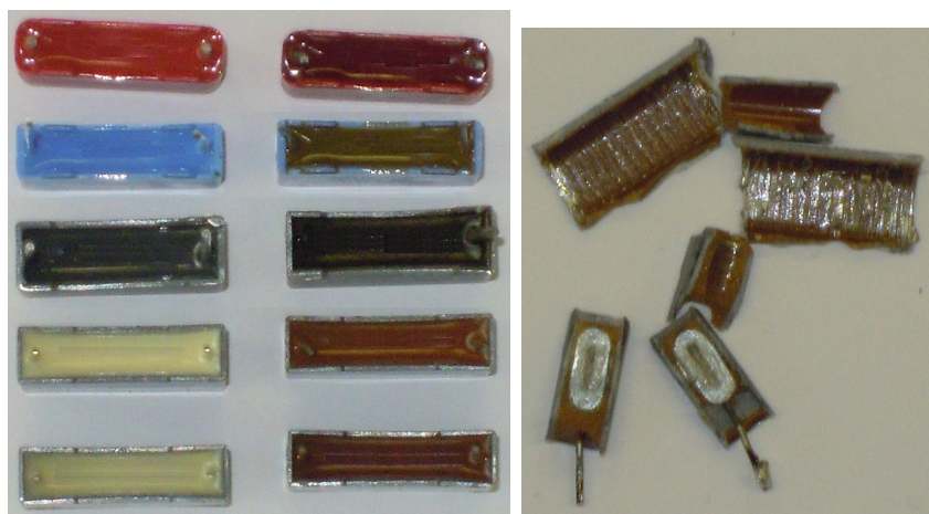
(a) Změna barvy zalévací hmoty (b) Degradace zalévací hmoty
