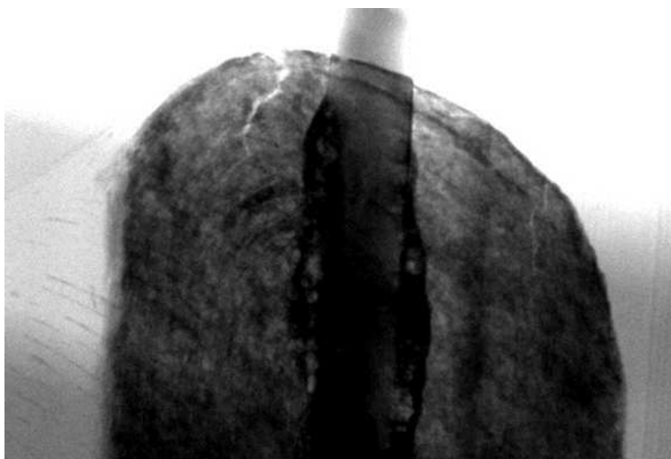
Obrázek 4.17: RTG analýza, praskliny v našopované vrstvě
