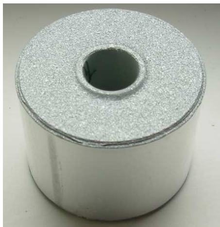
Obrázek 1.6: Svitek s našopovanou vrstvou zinku
