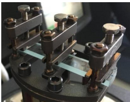
Obr. 4.5 - Detail způsobu upnutí zkušebního tělesa ve stroji pro DMA analýzy v nástavci „Dual Cantilever“
