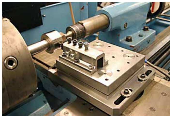
Měření řezných sil při soustružení (foto: archiv ústavu)
