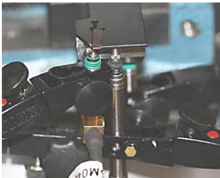
Ověřování tuhostních charakteristik soustružnických planžet (foto: archiv ústavu)
