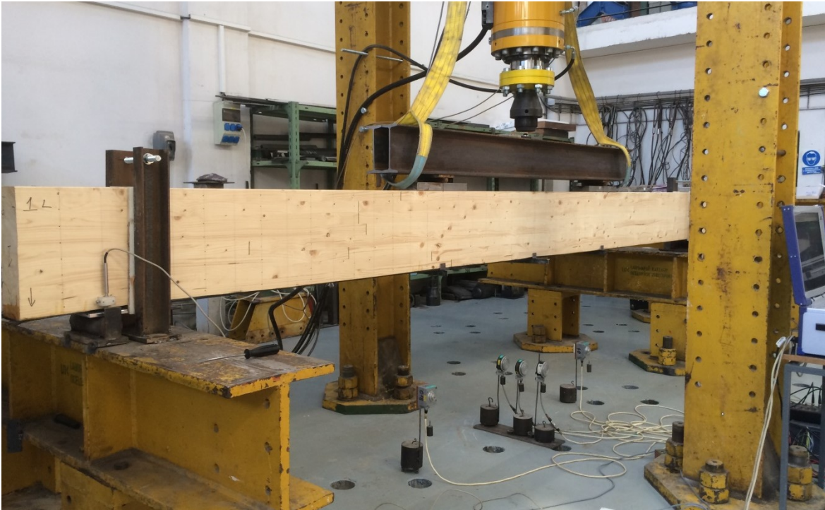
Obrázek č. 45 Nosník z LLD připraven na zatěžovací zkoušku 62
