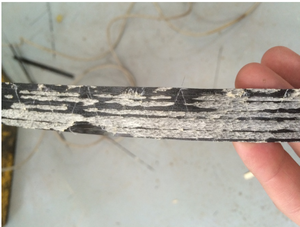
Obrázek č. 48 Vzorek uhlíkové tkaniny odtržený při porušení nosníku 66
