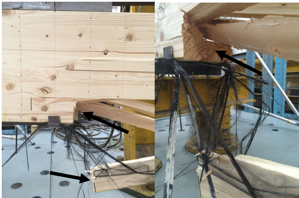
Obrázek č. 47 Detail počátku poruchy vyztuženého nosníku 65
