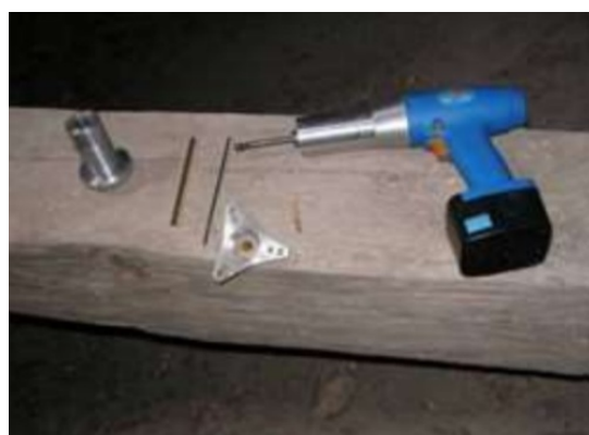
Obrázek č. 18 Vrtačka upravená pro odběr vzorků 31
