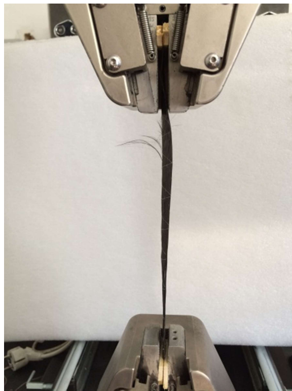
Obrázek č. 53 Uchycení prvního vzorku první sady do trhacího stroje – patrné zkroucení tkaniny 72
