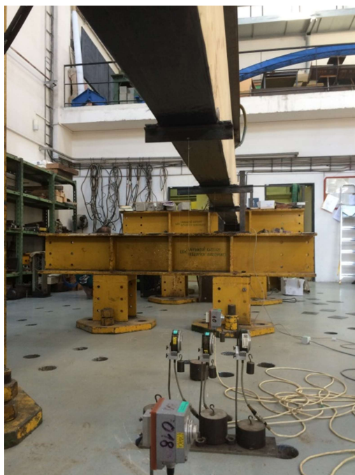
Obrázek č. 44 Pohled na spodní okraj vyztuženého nosníku a měřící zařízení 60
