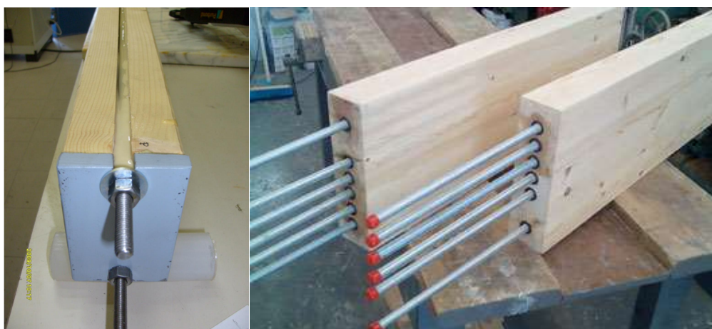
Obrázek č. 38 Předepjaté ocelové tyče spojené lepidlem s nosníkem z LLD 53
