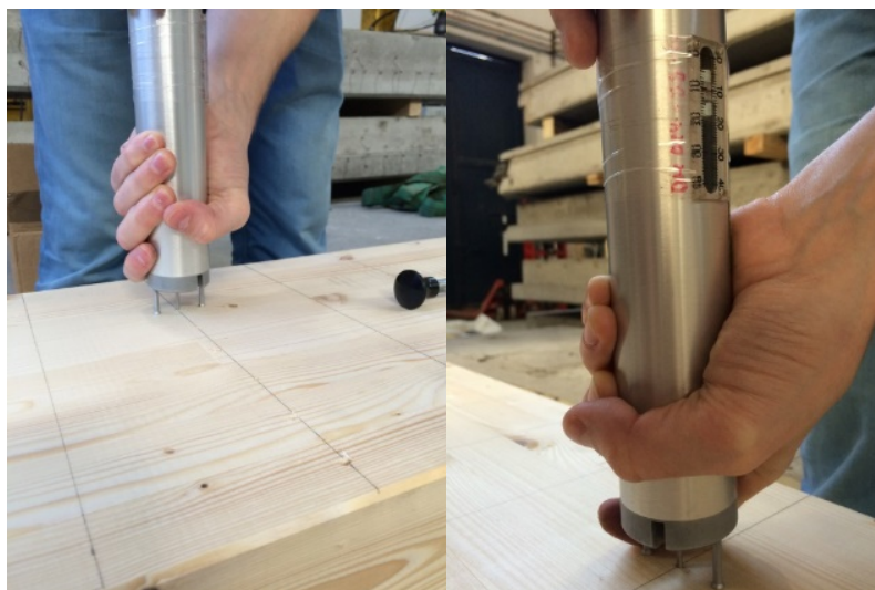
Obrázek č. 28 Testovaný nosník z LLD a měření s odečítáním hodnot z přístroje Pilodyn 6J 44
