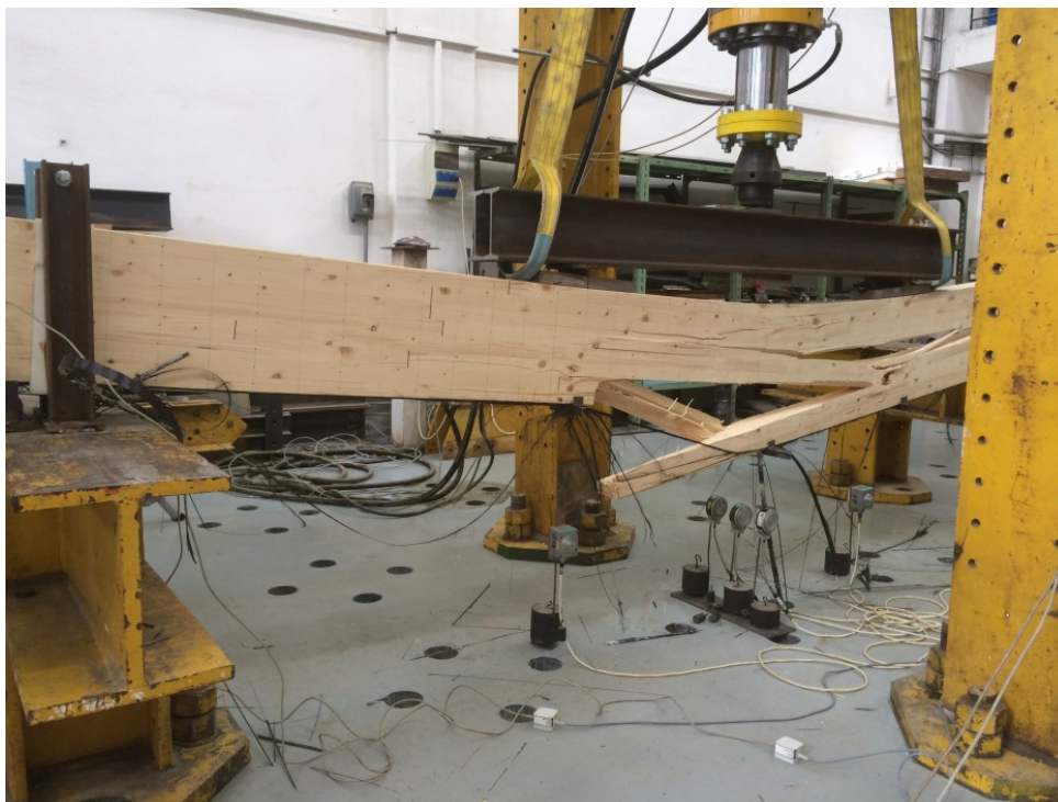
Obrázek č. 46 Vyztužený nosník krátce po porušení a ukončení zatěžovací zkoušky 63
