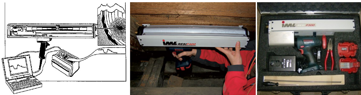
Obrázek č. 17 Princip měření (vlevo), mikrovrtáčka s rezistografem (vpravo) 30
