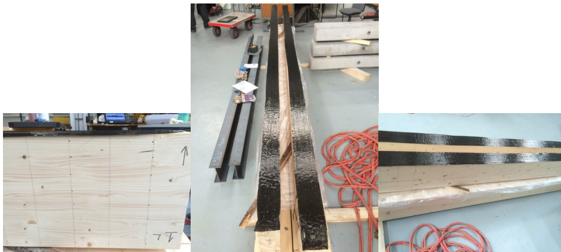
Obrázek č. 42 Nosníky připravené k destruktivnímu zkoušení 57
