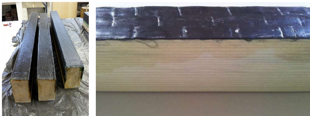
Obrázek č. 39 Dřevěné nosníky s přilepenou tkaninou z uhlíkových vláken 54
