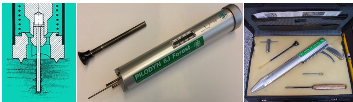
Obrázek č. 16 Princip měření (vlevo), pilodyn a potřebné vybavení (vpravo) 29
