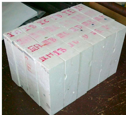
Obrázek 3-5 2. část tvárnice vyjmuté z fasády (pohled z exteriéru – vrstva A)
