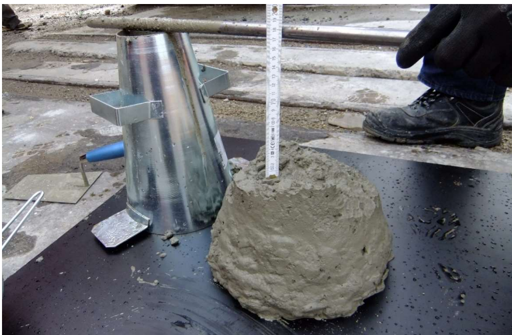
Obrázek 3-17 Provádění zkoušky sednutí kužele
