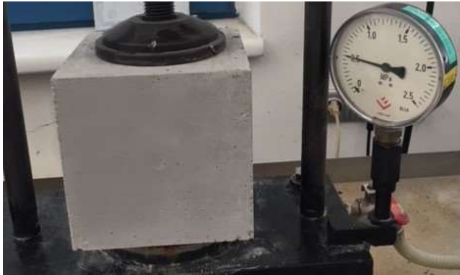
Obrázek 2-13 Zkouška hloubky průsaku tlakovou vodou – laboratoř
