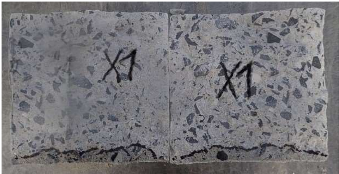
Obrázek 2-13 Zkouška hloubky průsaku tlakovou vodou – laboratoř
