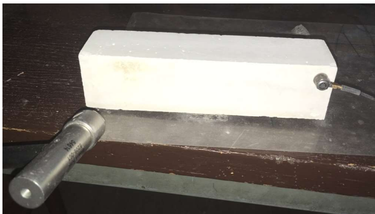
Obrázek 2-1 Těleso připravené pro rezonanční zkoušku (torzní kmitání)
