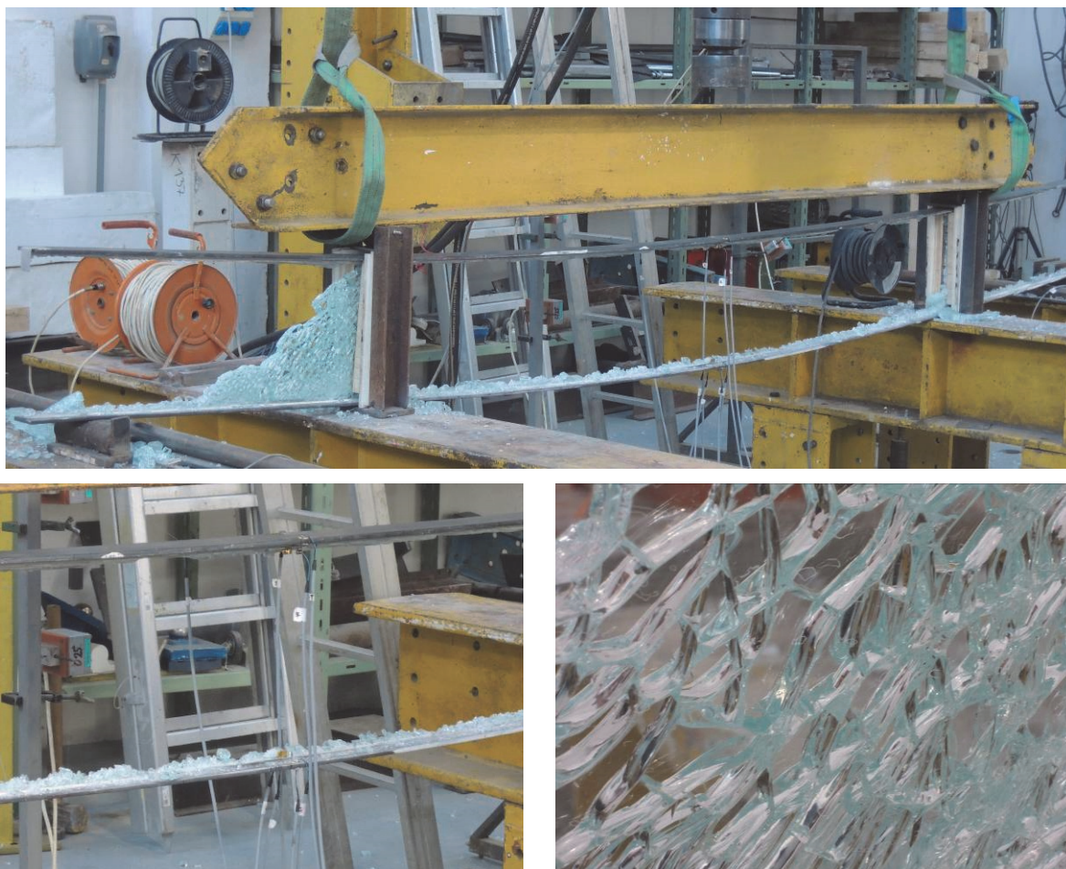
Obr. 45: Porušení nosníku při druhém experimentu
