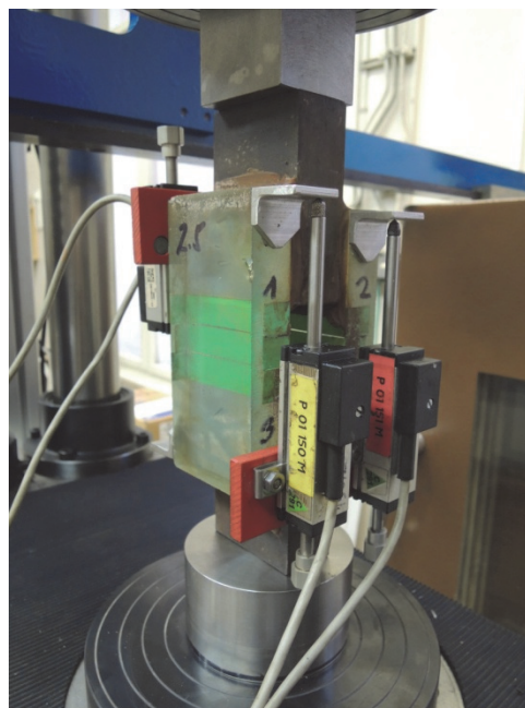
Obr. 36: Uspořádání smykových zkoušek lepeného spoje, nahoře – tah, dole – tlak
