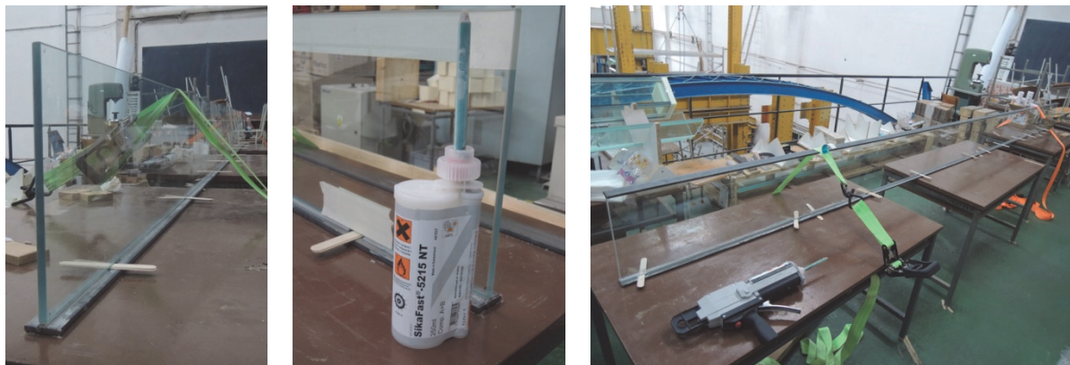
Obr. 47: Postup výroby hybridního nosníku
