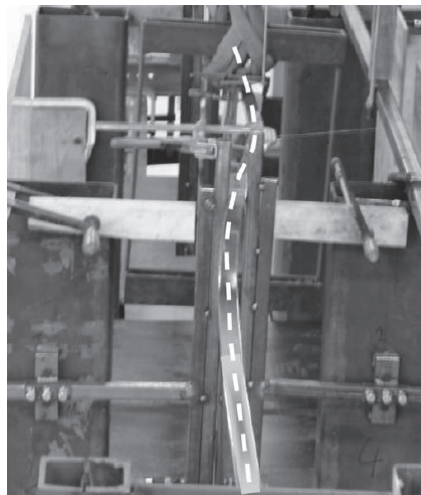
Obr. 21: Ztráta příčné a torzní stability, [25]
