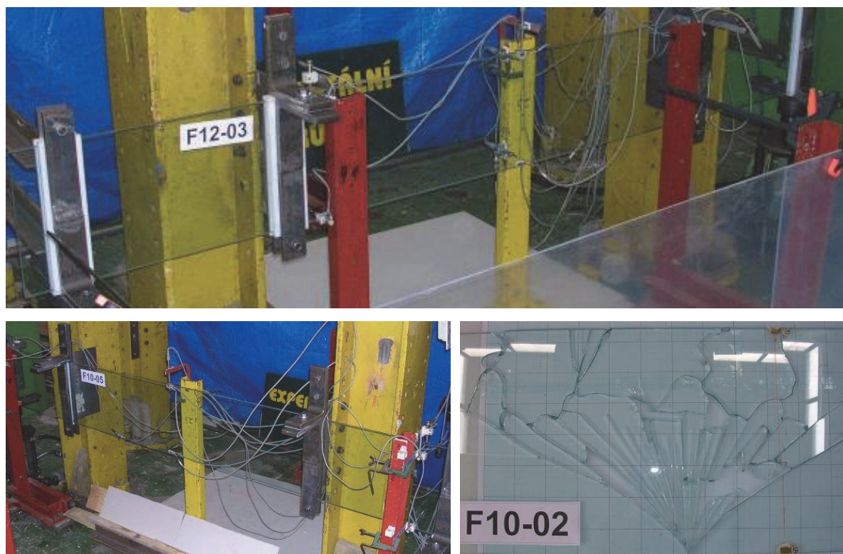
Obr. 28: Jednovrstvé sklo, nahoře a vlevo dole – uspořádání experimentů, vpravo dole – typické porušení vzorku, [28]
