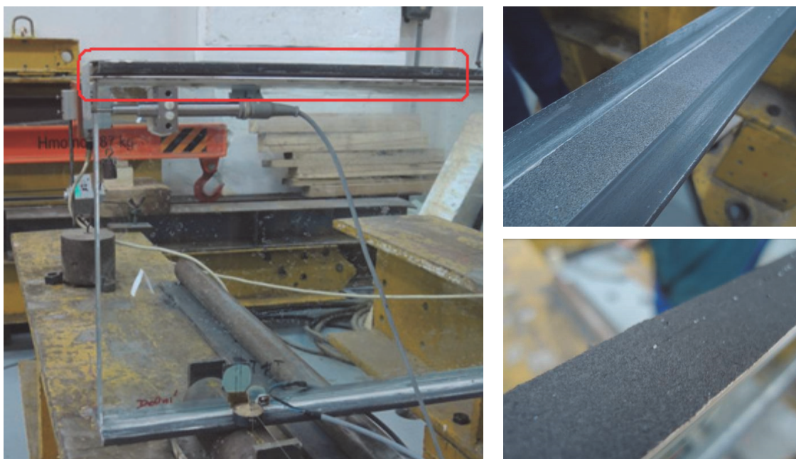
Obr. 44: Adhezní porušení lepeného spoje při prvním experimentu
