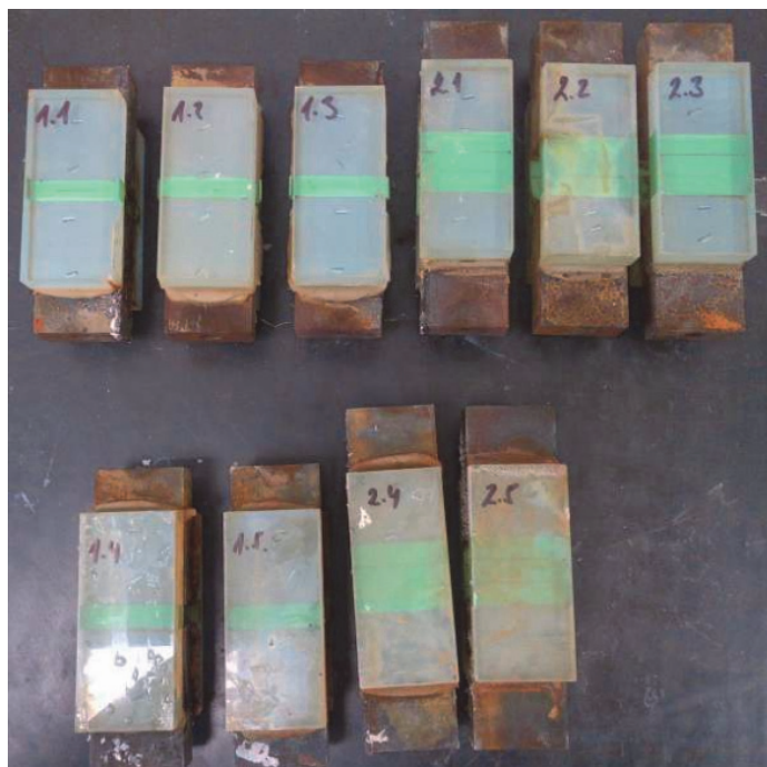
Obr. 34: Zkušební vzorky po provedeném umělém stárnutí
