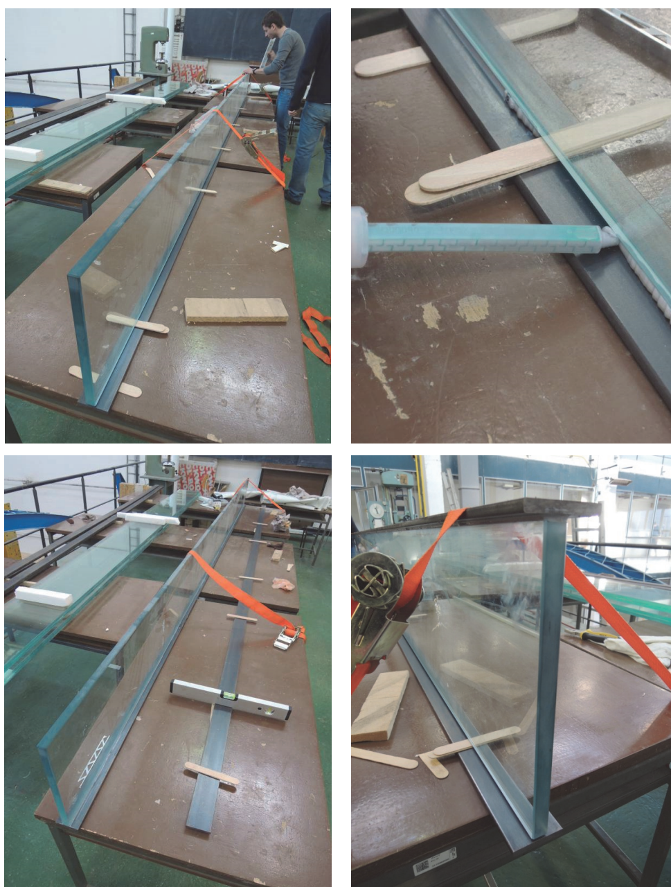
Obr. 40: Postup výroby hybridního nosníku
