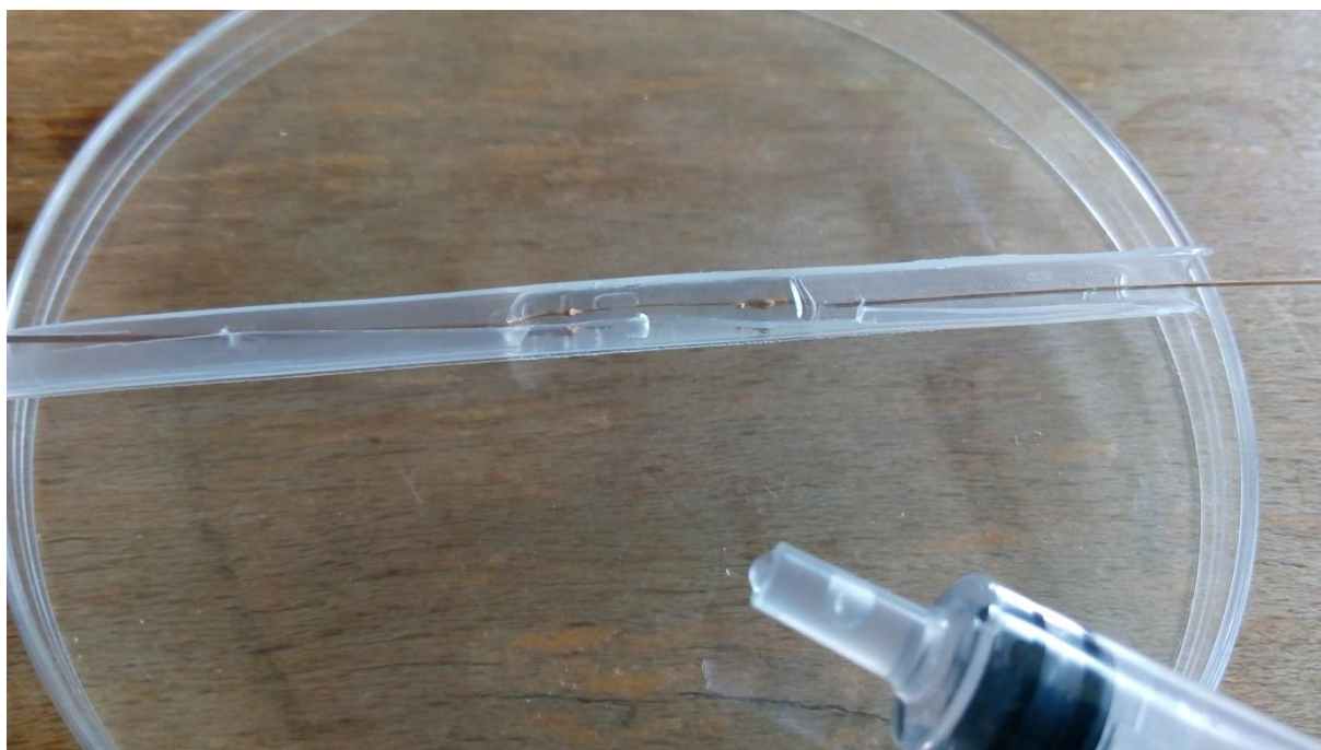
Obrázek 4.5 Detail měřeného vzorku, pokovená část vlákna (v délce přibližně 2 cm) je smáčena destilovanou vodou.
