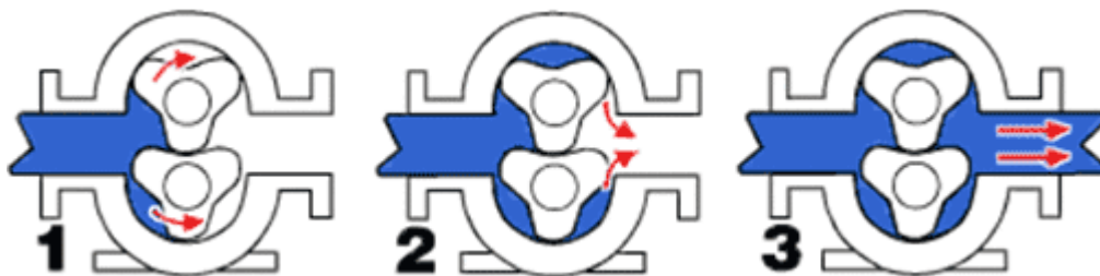
Obrázek 24 – Princip fungování lobe pumpy (na obrázku se třemi křídly) [13]
