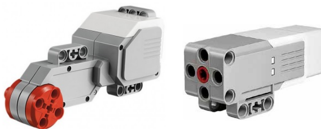
Obrázek 2.2. Velký a střední EV3 motor [5]
