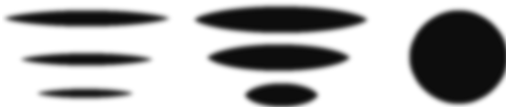
Obr. 7: Typicky dosahované (používané) tvary stříkaných paprsků při robotickém lakování
