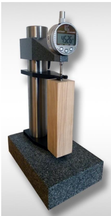
Obrázek 9: Příklad na měření volného smrštění, svislý stojánek [34]
