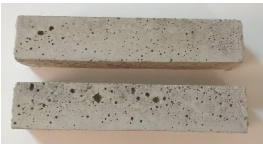
Obrázek 55: Povrchové póry na vzorcích se shodným ošetřováním
