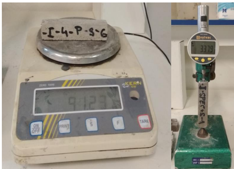
Obrázek 23: VLEVO: Stanovení hmotnosti trámečků pro smrštění
