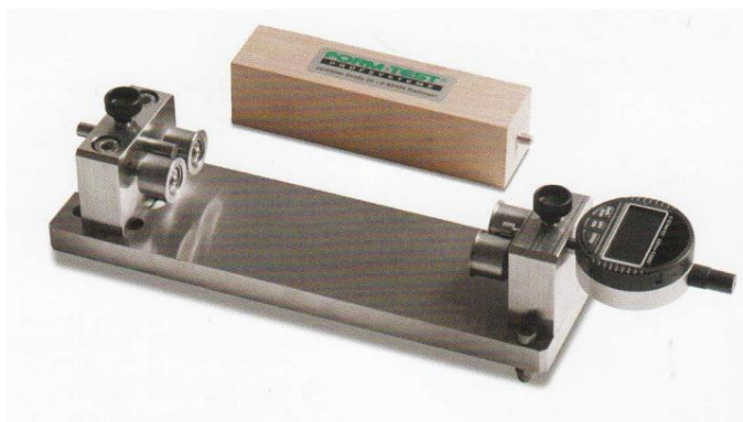
Obrázek 10: Příklad na měření volného smrštění, vodorovný stojan [34]
