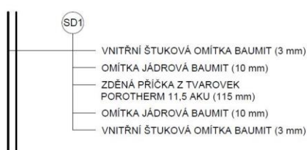
Obr. 21 – Skladby VAR.1 (zděná konstrukce), VAR.1 (zděná příčka) a VAR.2 (SDK příčka)
