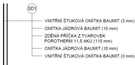
Obr. 22 – Skladby VAR. 2 (ŽB konstrukce), VAR.1 (zděná příčka) a VAR.2 (SDK příčka)
