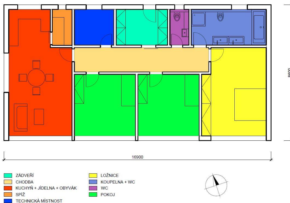
Obr. 19 - Výsledná dispozice s technickou místností
