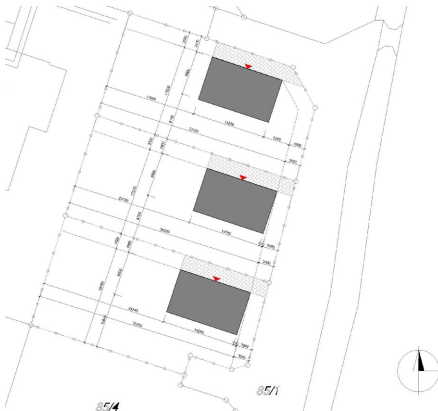
Obr. 8 - Podélné umístění objektu na pozemku VAR.1
