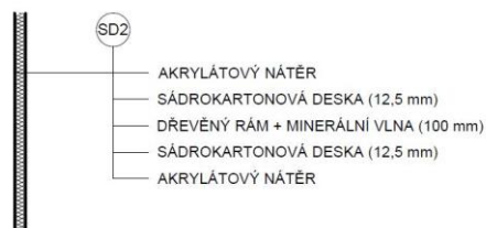
Obr. 22 – Skladby VAR. 2 (ŽB konstrukce), VAR.1 (zděná příčka) a VAR.2 (SDK příčka)
