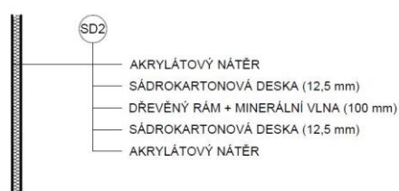
Obr. 21 – Skladby VAR.1 (zděná konstrukce), VAR.1 (zděná příčka) a VAR.2 (SDK příčka)
