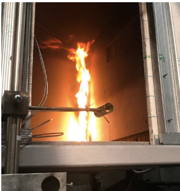
obr. 51: tvořící se kouřová vrstva v čase 503 s a plameny dosahující ke stropu
