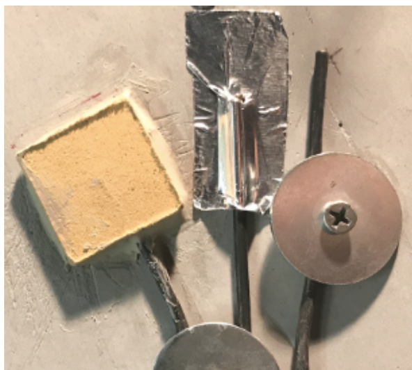
obr. 45: TC pod stropem pro měření povrchové teploty, vlevo TC pod deskou Nefalit s lepidlem, uprostřed připevněn TC hliníkovou samolepicí páskou, vpravo TC bez zakrytí měřicího bodu mechanicky kotven podložkou a vrutem
