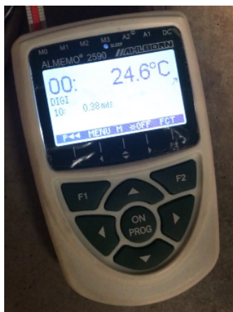
obr. 49: anemometr v průběhu měření rychlosti proudění a teploty
