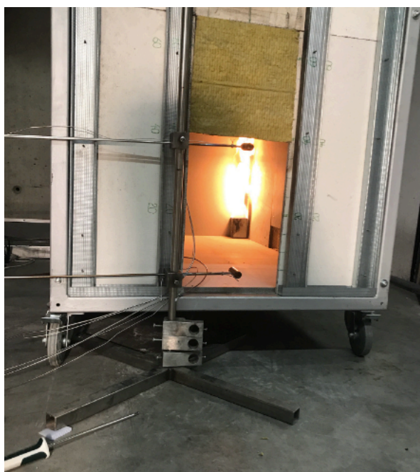
obr. 50: místnost po cca 4,5 minutách po začátku experimentu při výkonu hořáku 11,1 kW, na zemi u stojanu je měřicí tyč pro anemometr
