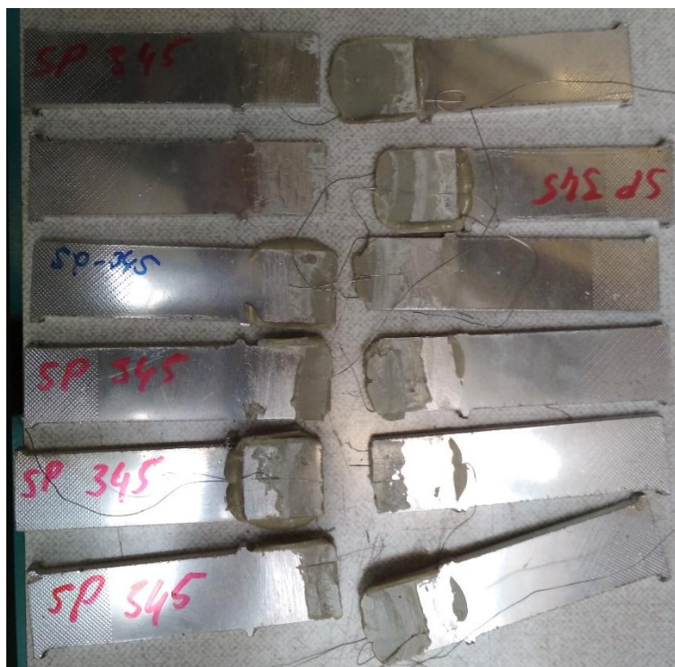
Obrázek A.54: Porušené hliníkové vzorky
