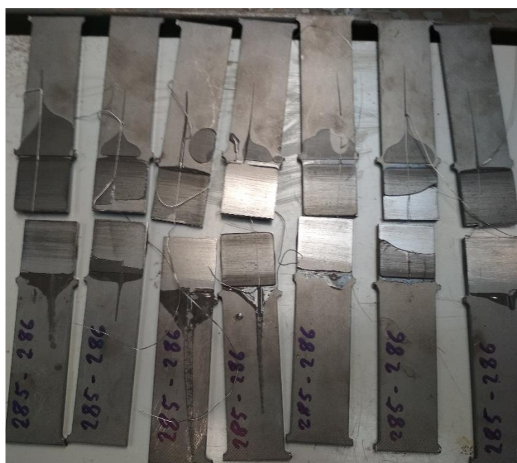
Obrázek A.78: Porušené ocelové vzorky
