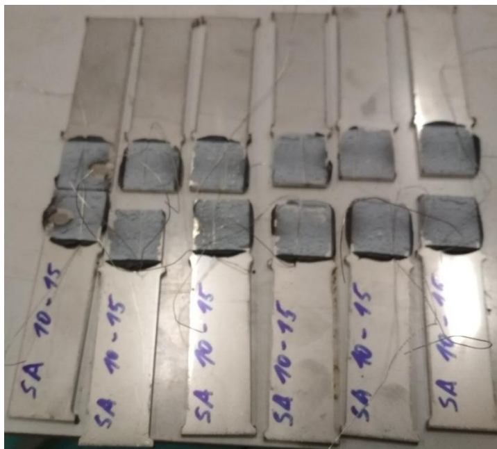
Obrázek 5.12: Porušené nerezové vzorky
