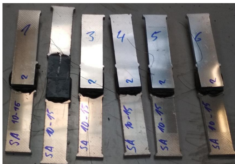
Obrázek 5.10: Porušené hliníkové vzorky
