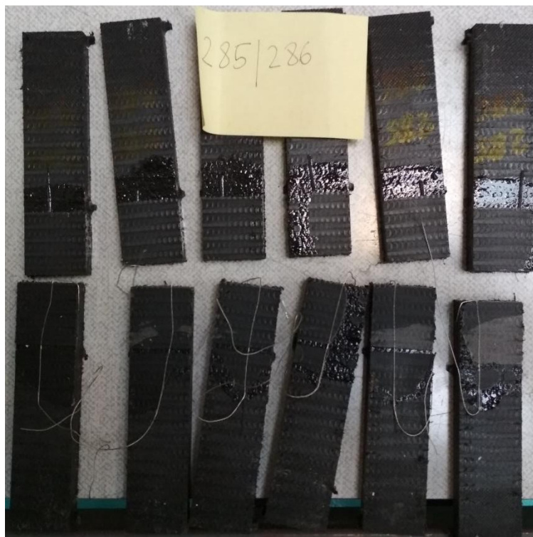
Obrázek A.82: Porušené ertacetalové vzorky
