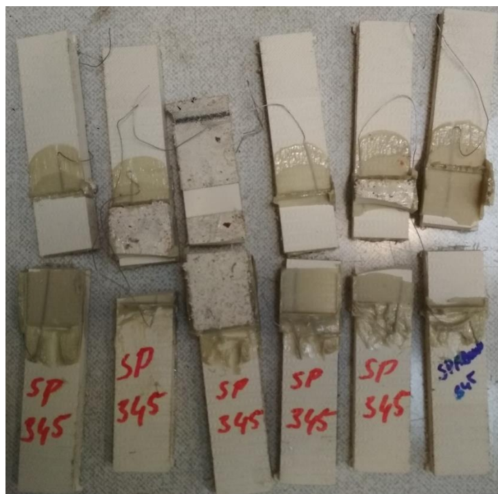
Obrázek A.60: Porušené vzorky z PVC
