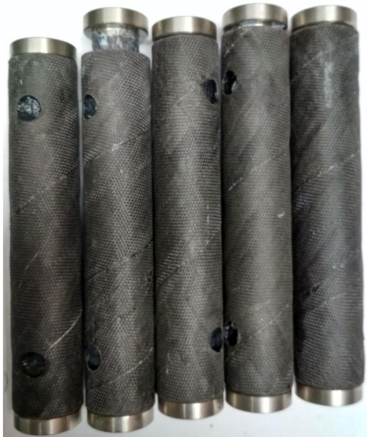
Obrázek 6.8: Porušené hladké vzorky
