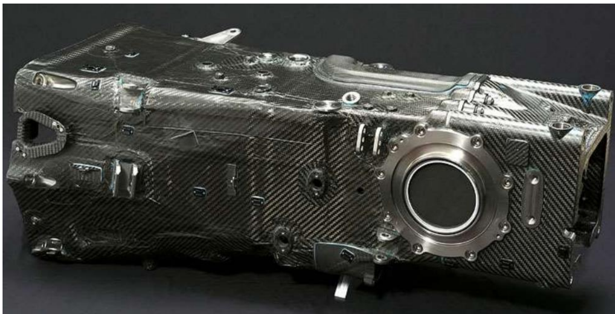
Obrázek 4.1: Kompozitní skříň převodovky závodního vozu Audi [15]
