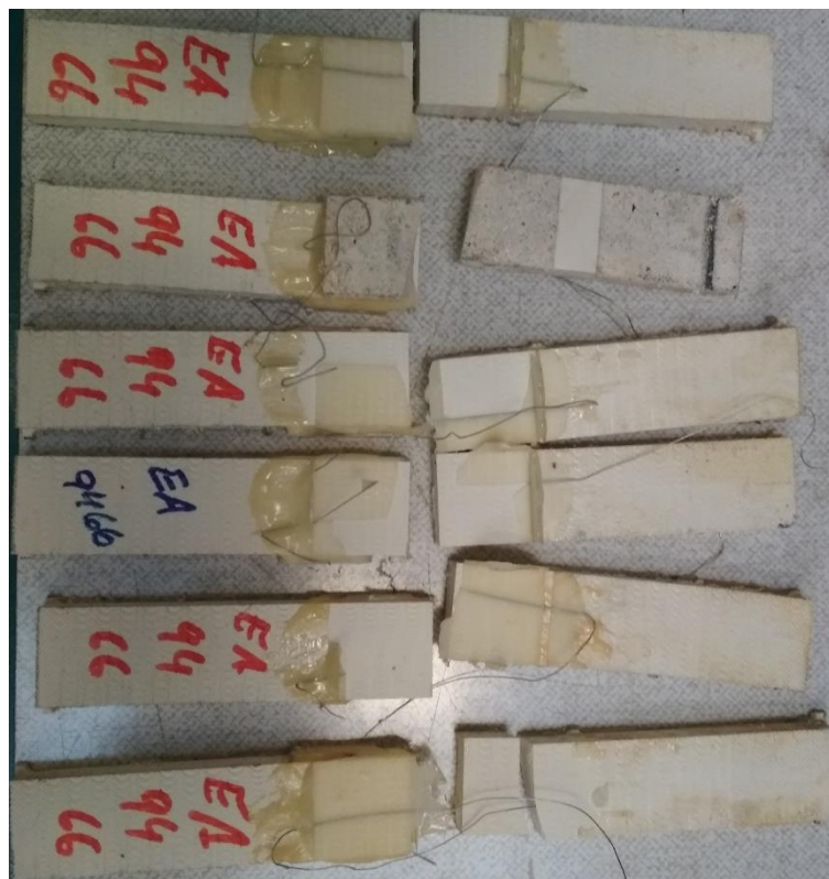
Obrázek A.12: Porušené vzorky z PVC
