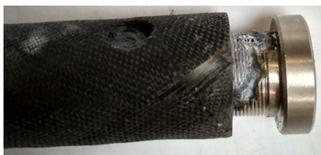
Obrázek 6.6: Detailní pohled na porušený vzorek
