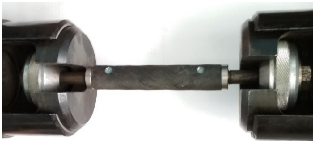
Obrázek 6.3: Trubkový vzorek upnutý v čelistech
