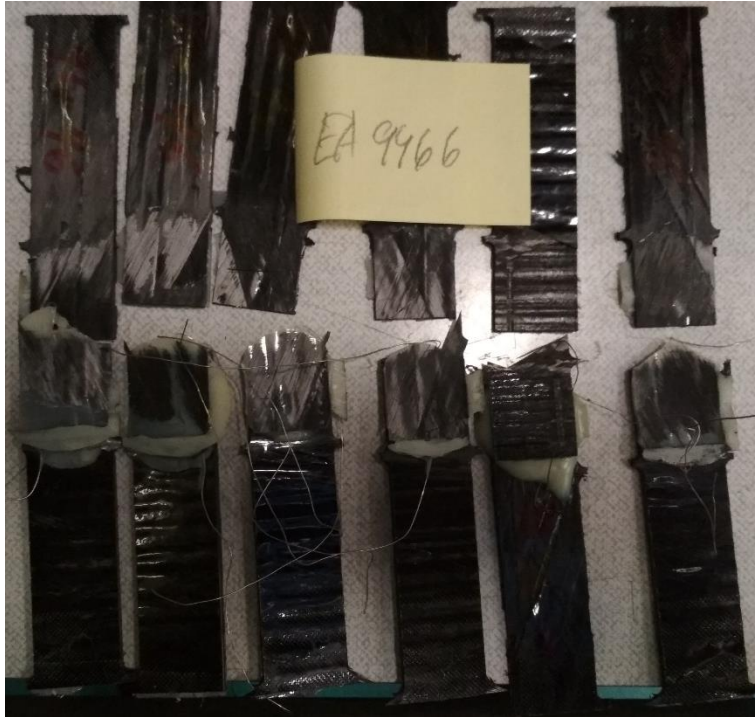
Obrázek A.2: Porušené uhlíkové vzorky
