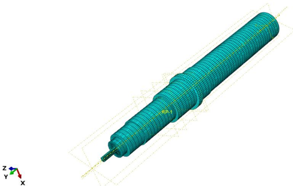
Obrázek 4.14: Zobrazení vytvořené sítě na hřídeli
