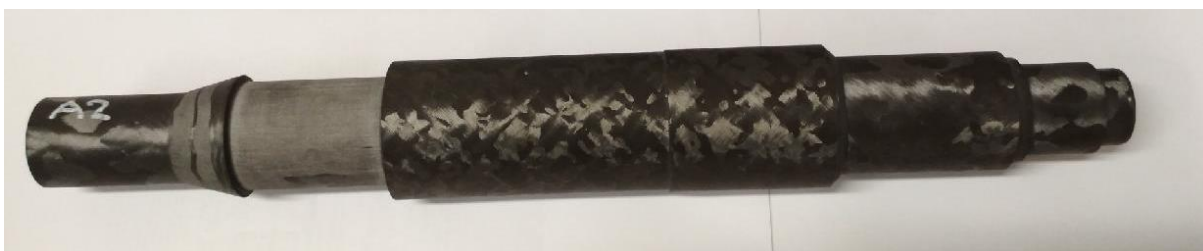
Obrobená kompozitní hřídel vyrobená navíjením vláken
