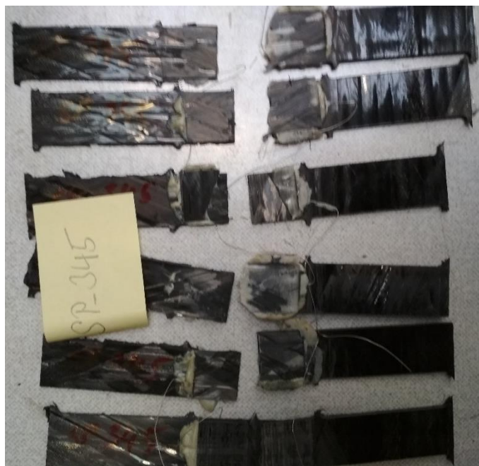
Obrázek A.50: Porušené uhlíkové vzorky
