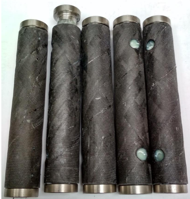
Obrázek B.4: Porušené hladké vzorky
