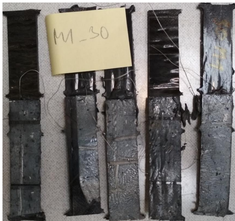
Obrázek A.26: Porušené uhlíkové vzorky
