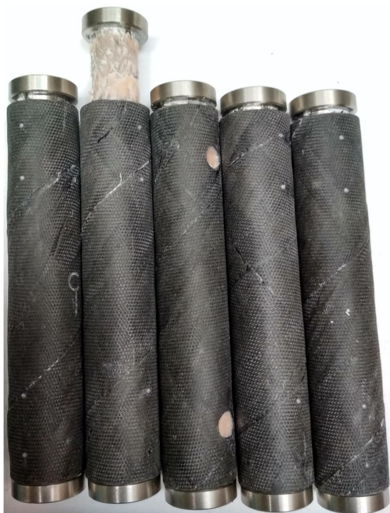
Obrázek B.8: Porušené vzorky s drážkou
