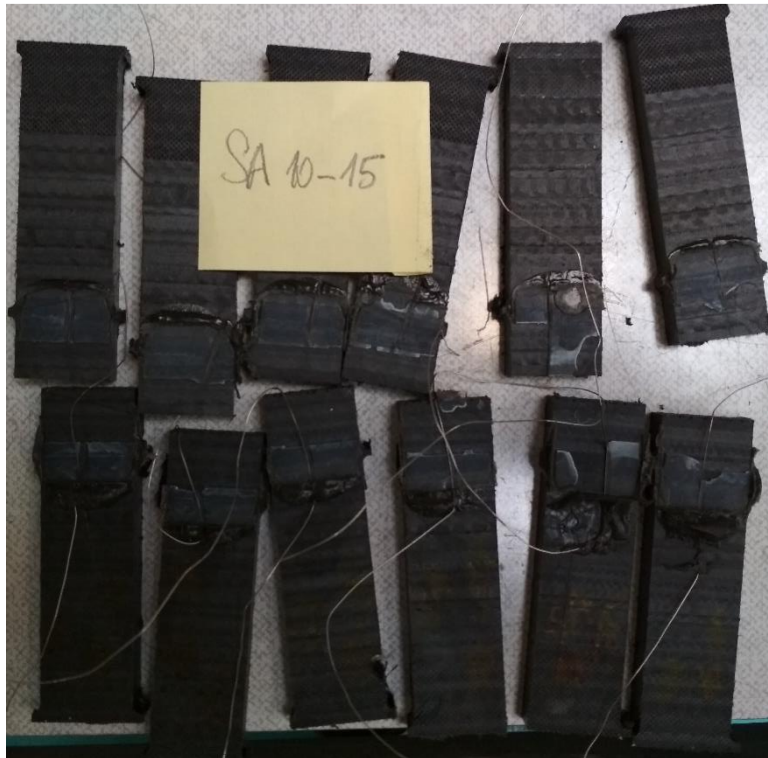
Obrázek 5.14: Porušené ertacetalové vzorky
