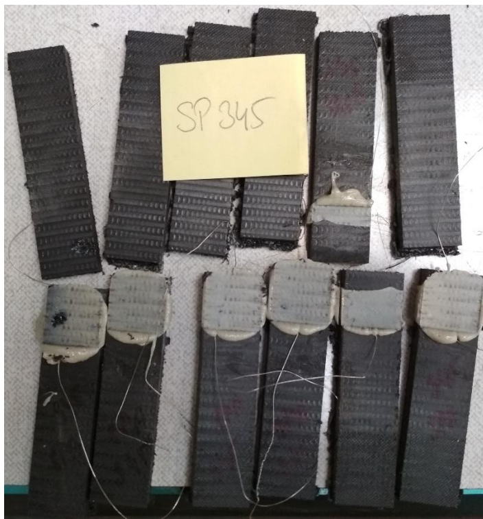
Obrázek A.58: Porušené ertacetalové vzorky
