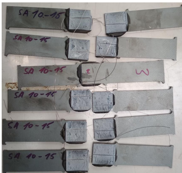
Obrázek 5.8: Porušené ocelové vzorky
