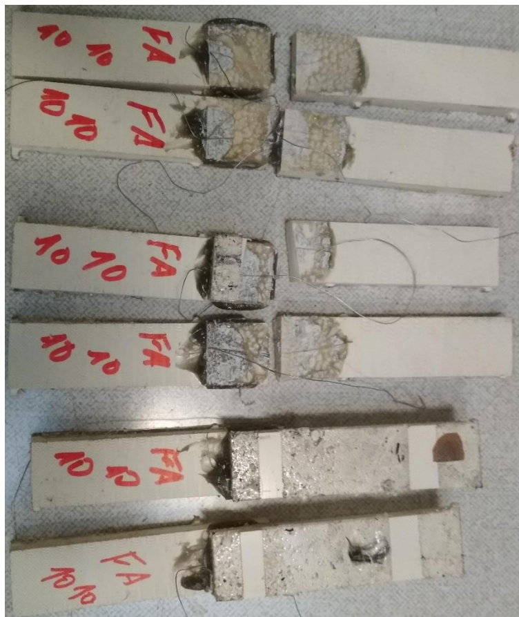
Obrázek A.47: Porušené vzorky z PVC
