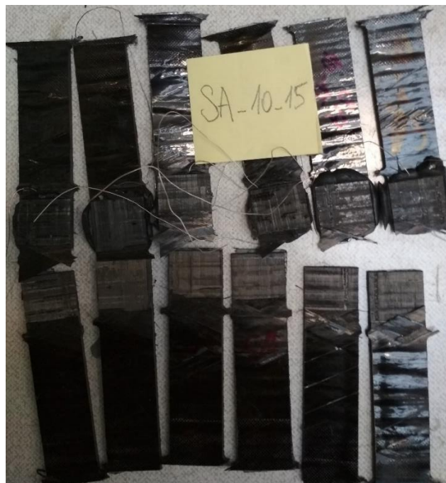
Obrázek 5.6: Porušené uhlíkové vzorky
