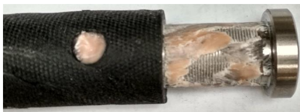
Obrázek B.9: Detailní pohled na porušený vzorek
