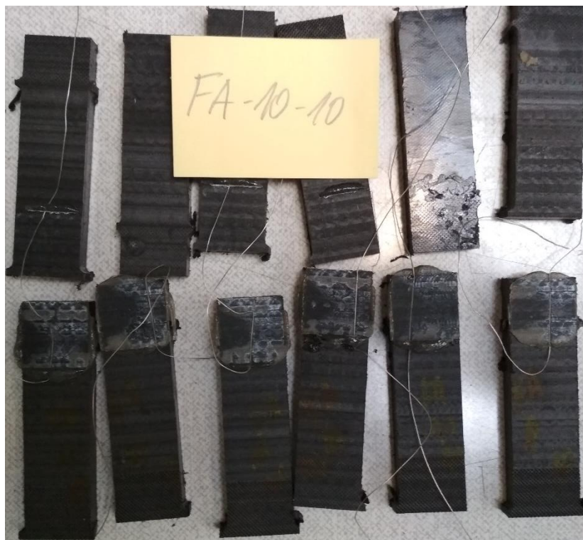
Obrázek A.45: Porušené ertacetalové vzorky
