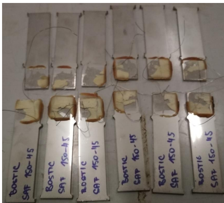
Obrázek A.69: Porušené nerezové vzorky
