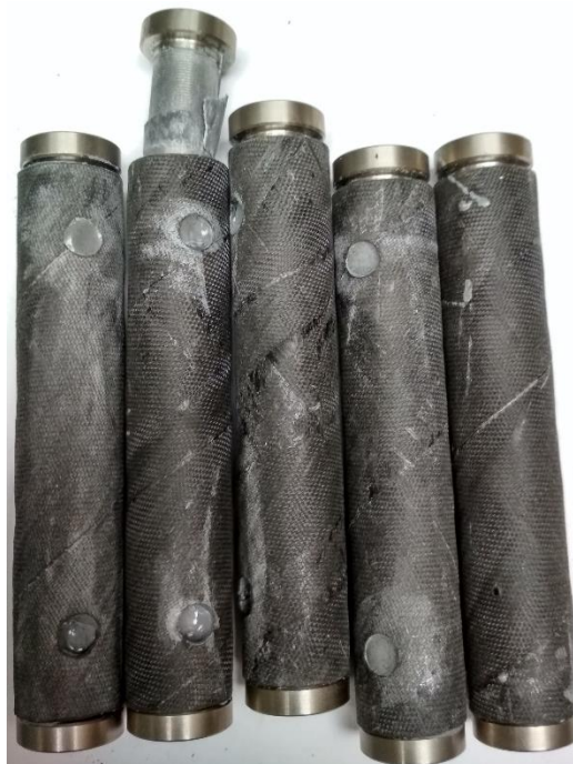
Obrázek B.6: Porušené vzorky s drážkou
