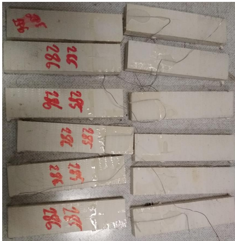
Obrázek A.84: Porušené vzorky z PVC
