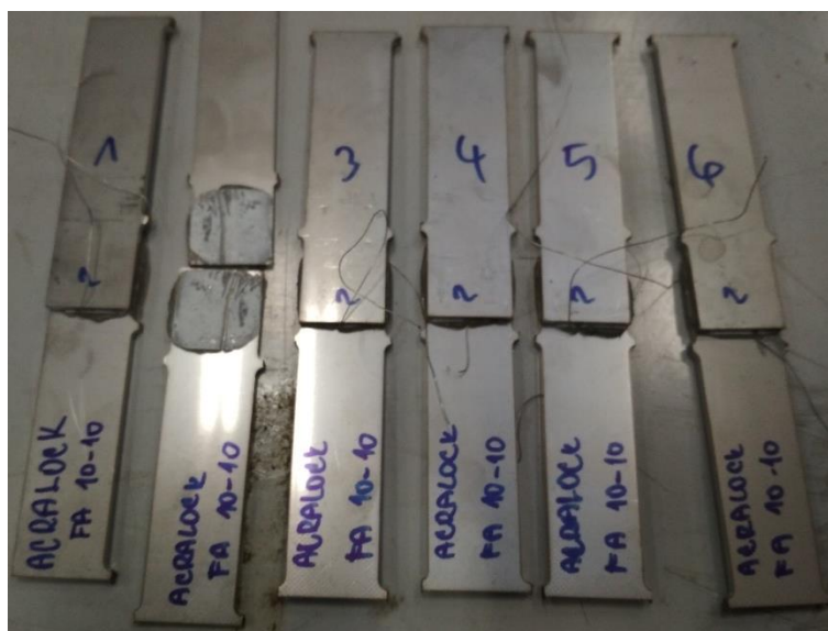
Obrázek A.43: Porušené nerezové vzorky
