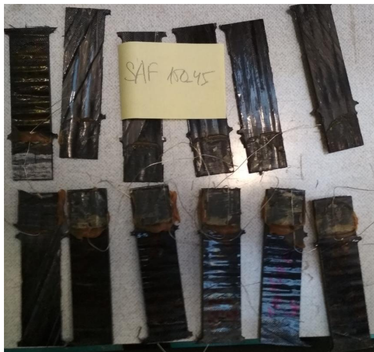
Obrázek A.63: Porušené uhlíkové vzorky
