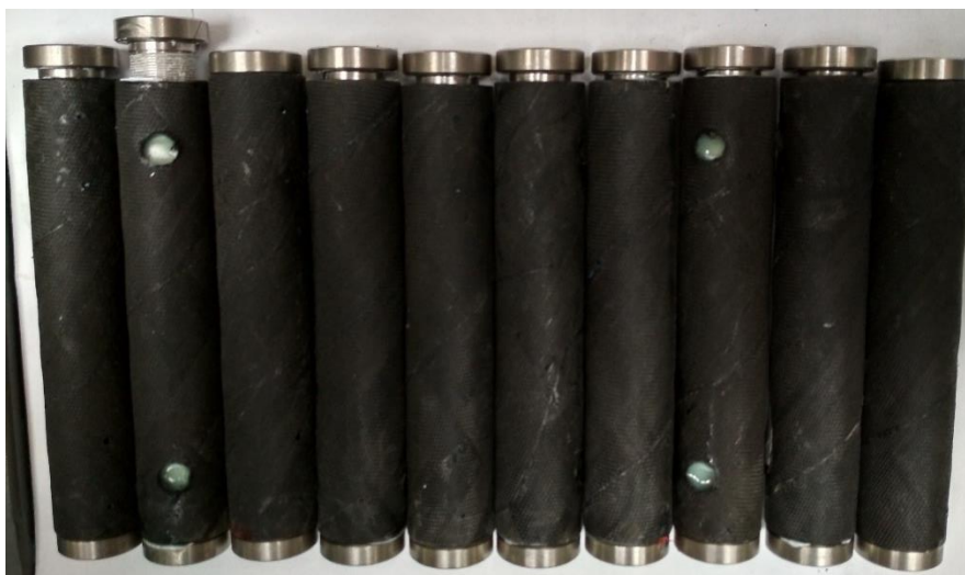
Obrázek B.2: Porušené vzorky s drážkou
