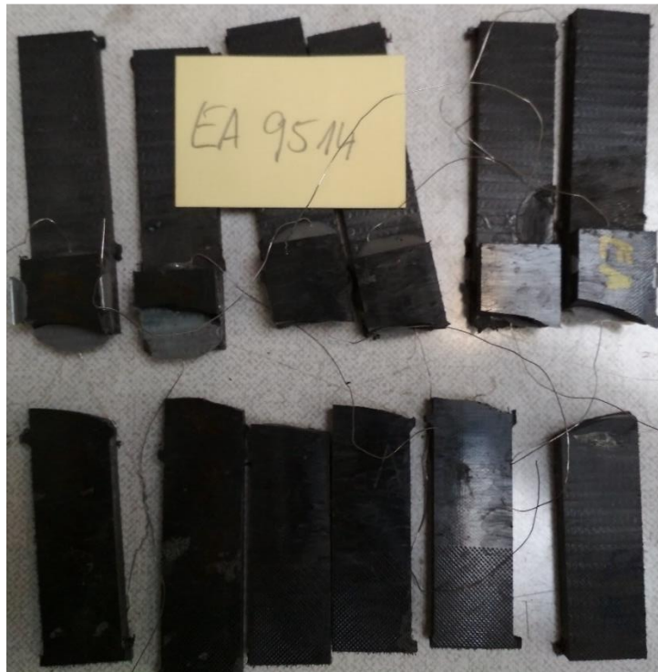
Obrázek A.23: Porušené ertacetalové vzorky
