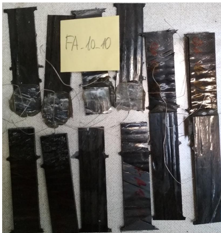
Obrázek A.37: Porušené uhlíkové vzorky
