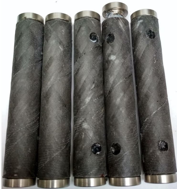
Obrázek 6.5: Porušené vzorky s drážkou
