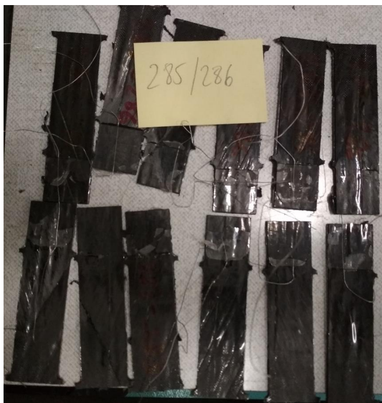
Obrázek A.76: Porušené uhlíkové vzorky
