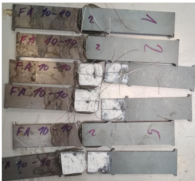
Obrázek A.39: Porušené ocelové vzorky
