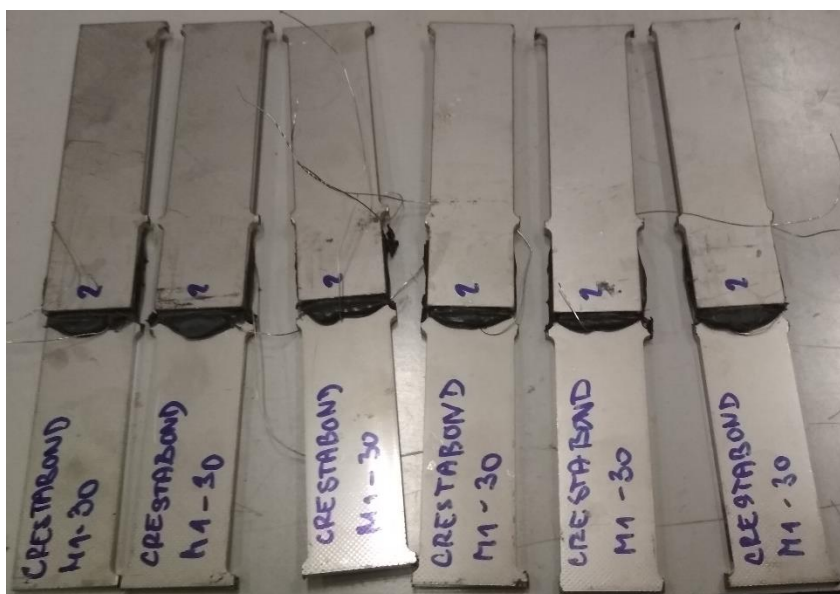
Obrázek A.32: Porušené nerezové vzorky
