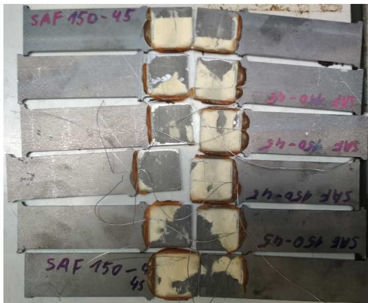
Obrázek A.65: Porušené ocelové vzorky
