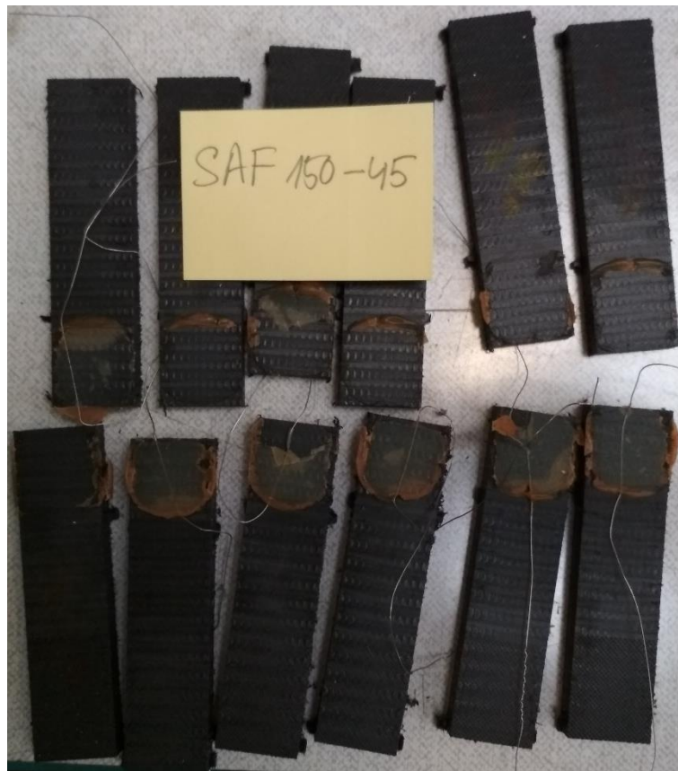
Obrázek A.71: Porušené ertacetalové vzorky
