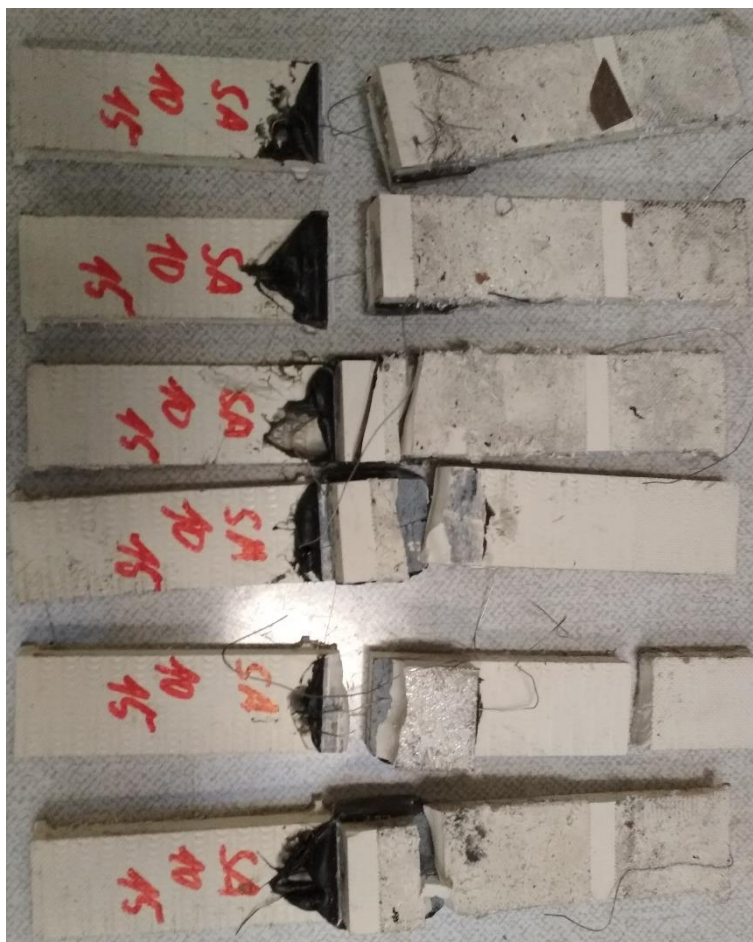
Obrázek 5.16: Porušené vzorky z PVC
