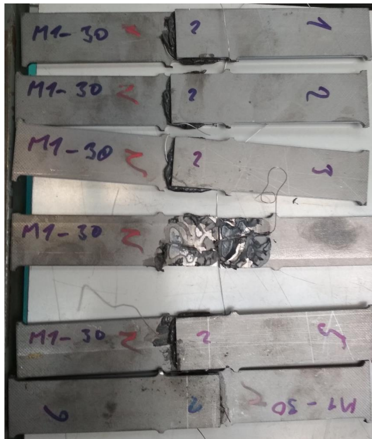
Obrázek A.28: Porušené ocelové vzorky
