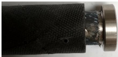
Obrázek 6.9: Detailní pohled na porušený vzorek
