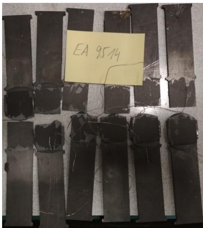
Obrázek A.17: Porušené ocelové vzorky
