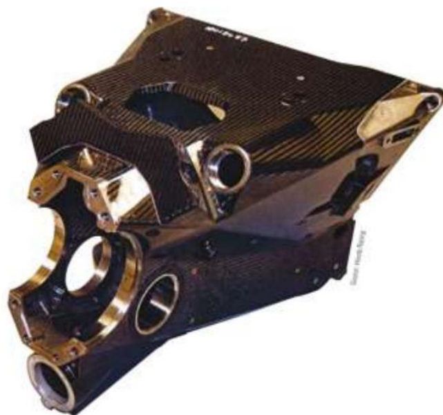
Obrázek 4.2: Kompozitní skříň převodovky vozu Formule 1 [15]
