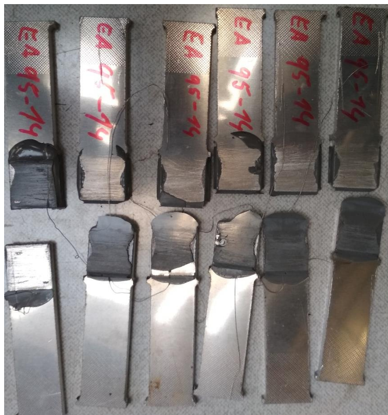
Obrázek A.19: Porušené hliníkové vzorky
