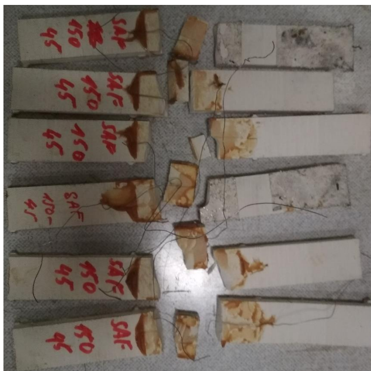
Obrázek A.73: Porušené vzorky z PVC
