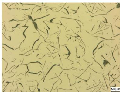
Obr. 9 - Mikrostruktura litiny EN-GJL-250 [13]
