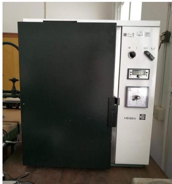
Obrázek 18 - Temperační komora, autor fotografie: Jan Vosáhl
