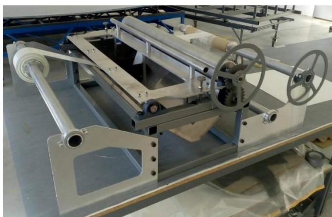
Obrázek 11 - Laboratorní aparatura k přípravě wet-pregu [17]
