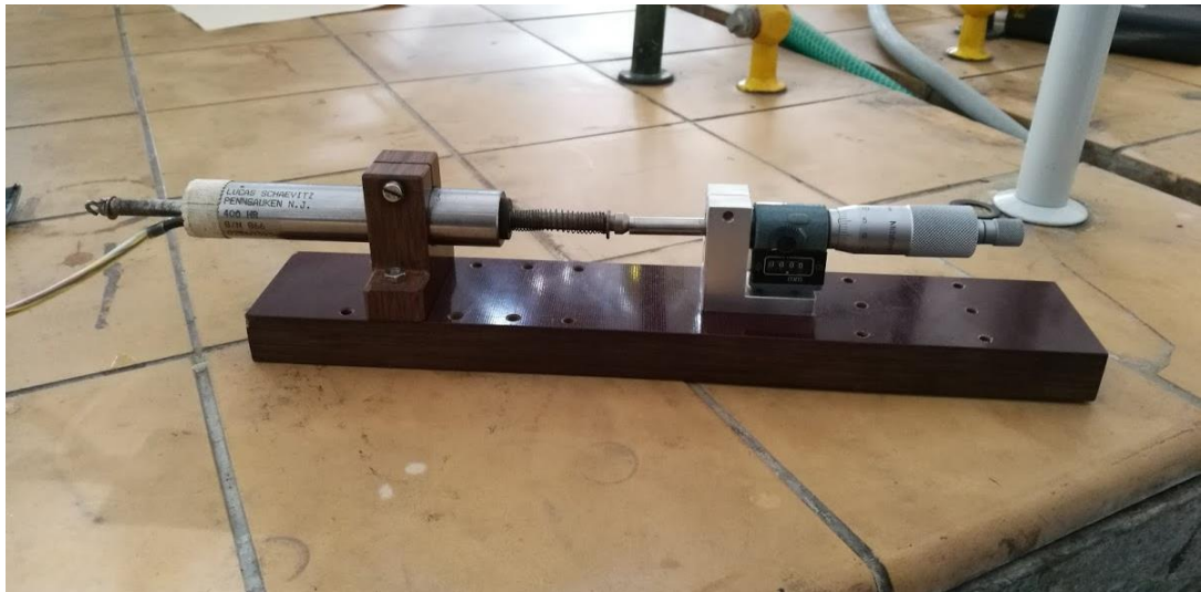
Obrázek 19 - Kalibrace LVDT snímače v měřicím přípravku, autor fotografie: Jan Vosáhl
