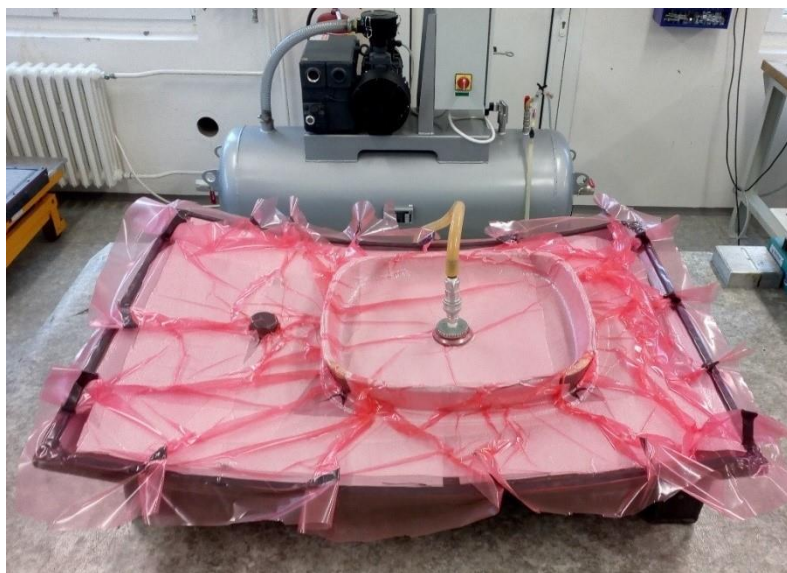
Obrázek 13 - Vakuové lisování panelu z geopolymerního wet-pregu [17]
