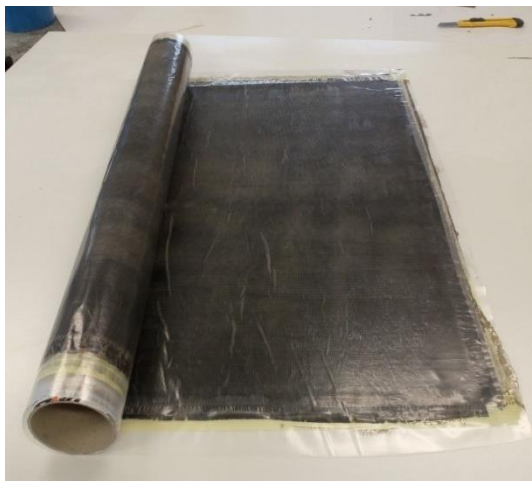
Obrázek 12 - Geopolymerní wet-preg s uhlíkovou tkaninou [17]
