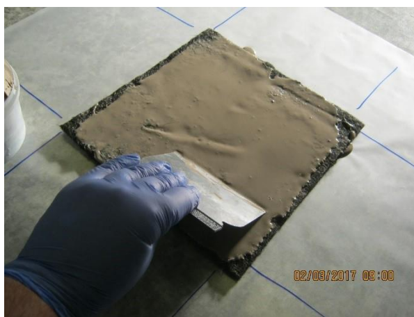
Obrázek 9 - Impregnace výztuže stěrkou [17]
