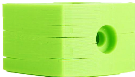
(b) Delaminace na rozhraní vrstev
