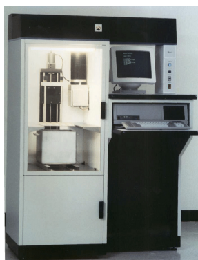
Obrázek 2: SLA-1 – První komerční 3D tiskárna na světě. Převzato z: [6].
