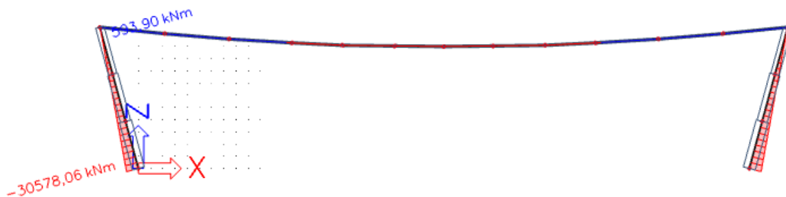
Obr. 29 Membránová konstrukce – vnitřní síly – M
