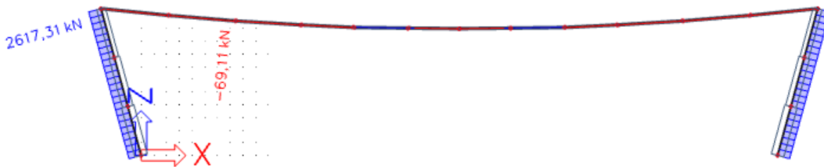
Obr. 28 Membránová konstrukce - vnitřní síly - V
