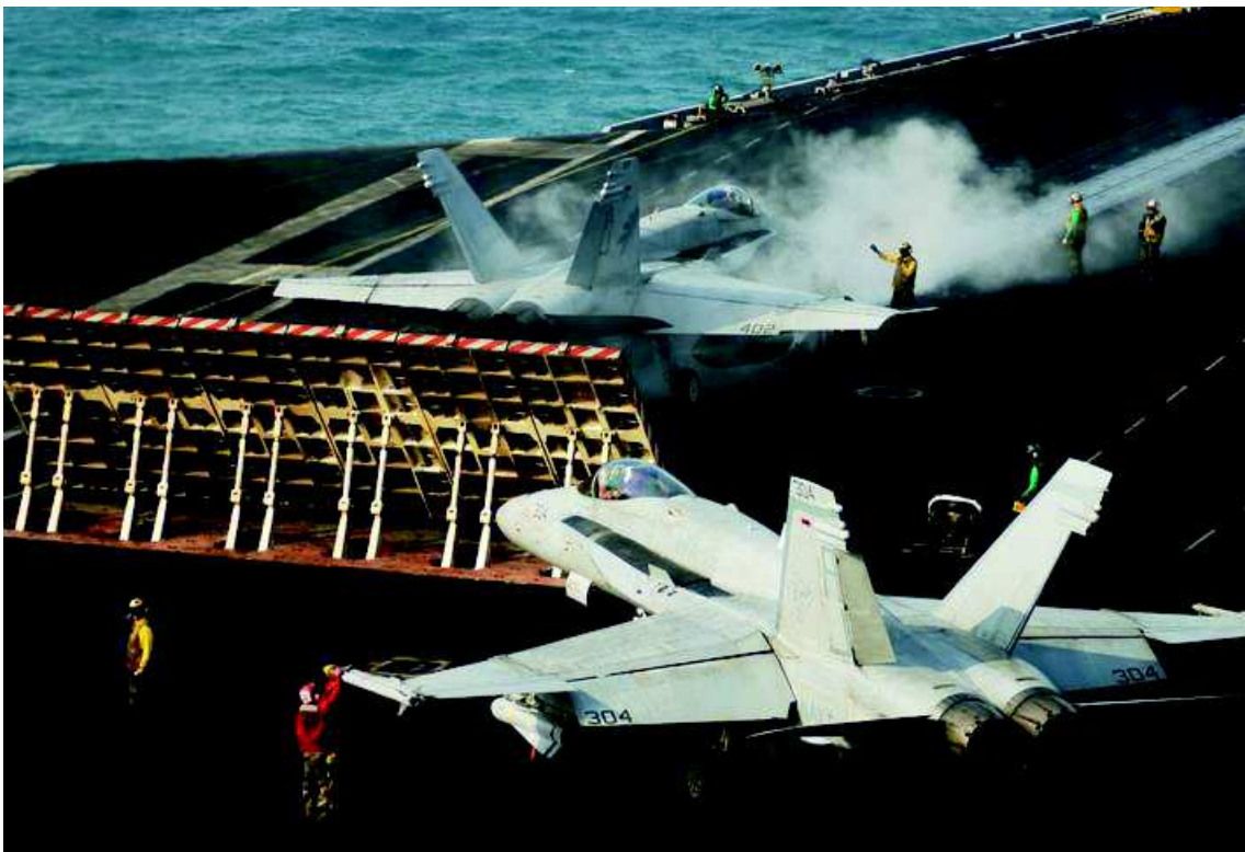
Obrázek 45-Deflektor chrání ostatní letouny na letadlové lodi před výtokovými plyny [1]
