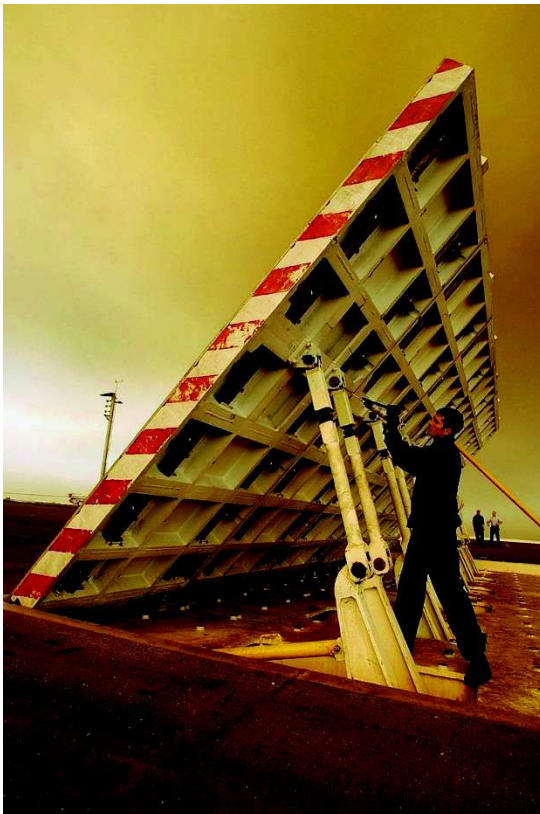
Obrázek 14-Obsluha deflektoru na palubě letadlové lodi před letovými operacemi [1]
