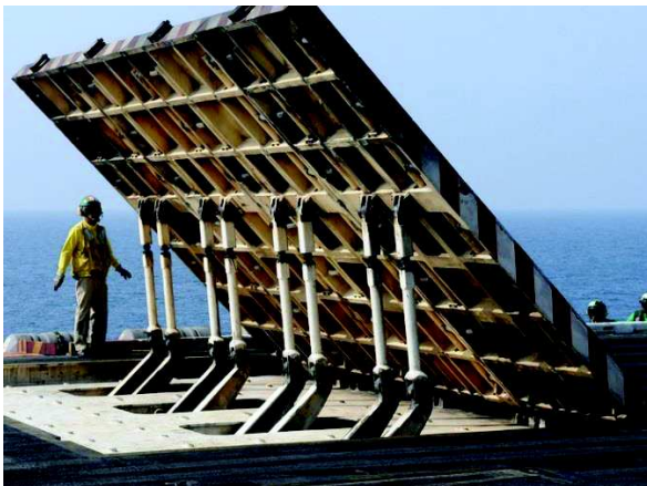
Obrázek 43- Zvedání deflektoru pomocí hydraulicky řízeného systému [1]
