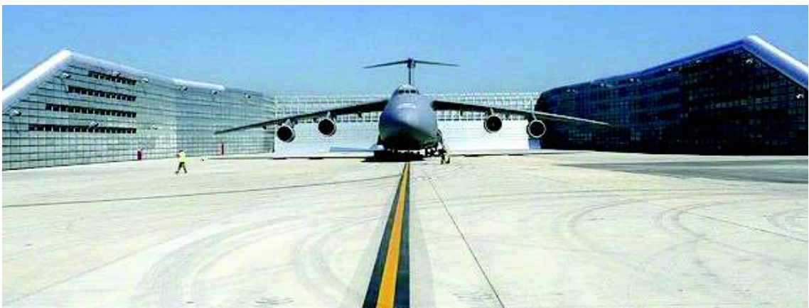
Obrázek 46-Testování (údržba) motorů letadla v „uzemňovací skříni“ [7]
