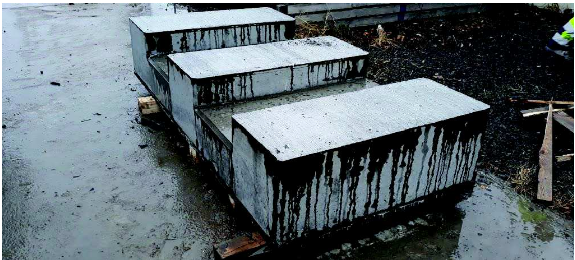
Obrázek 67-„Striáž“ na spodním povrchu tížného bloku
