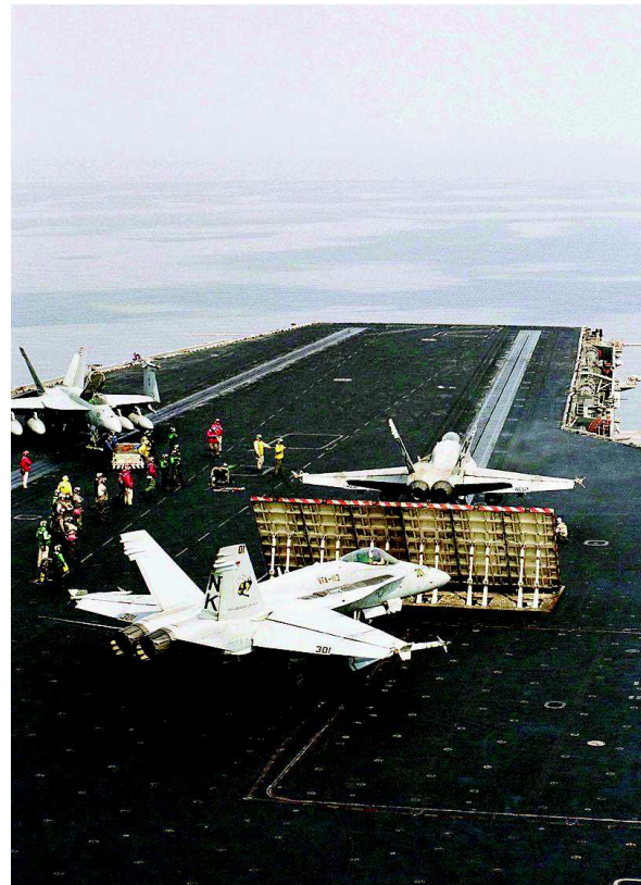
Obrázek 13-Zdvížení hydraulicky ovládaného deflektoru pro ochranu jiného letouny před výtokovými plyny [1]
