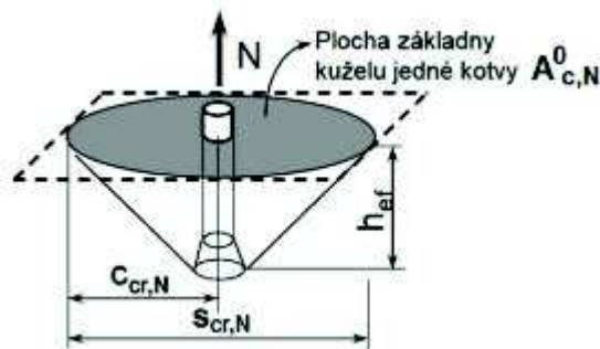
Obrázek 69-Rozměry betonového kužele [14]
