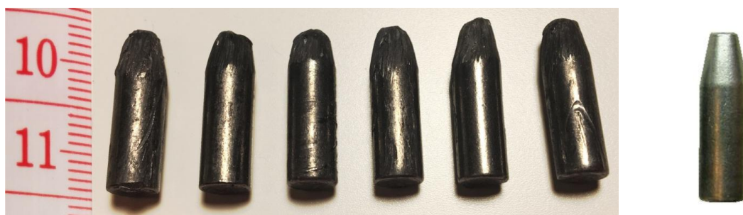
Obrázek 61: Ocelová jádra střel 7,62×39 mm
