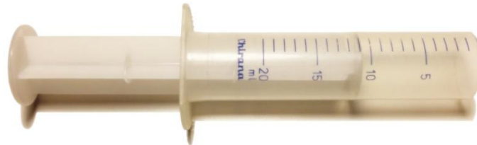
Obrázek 59: Injekční stříkačka pro plnění kráteru pískem
