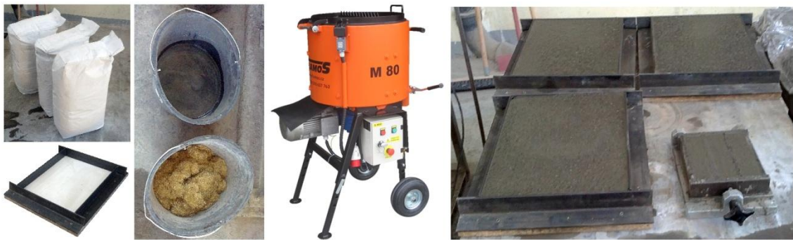
Obrázek 47: Komponenty UHPFRC, forma, laboratorní míchačka a uložená čerstvá směs
