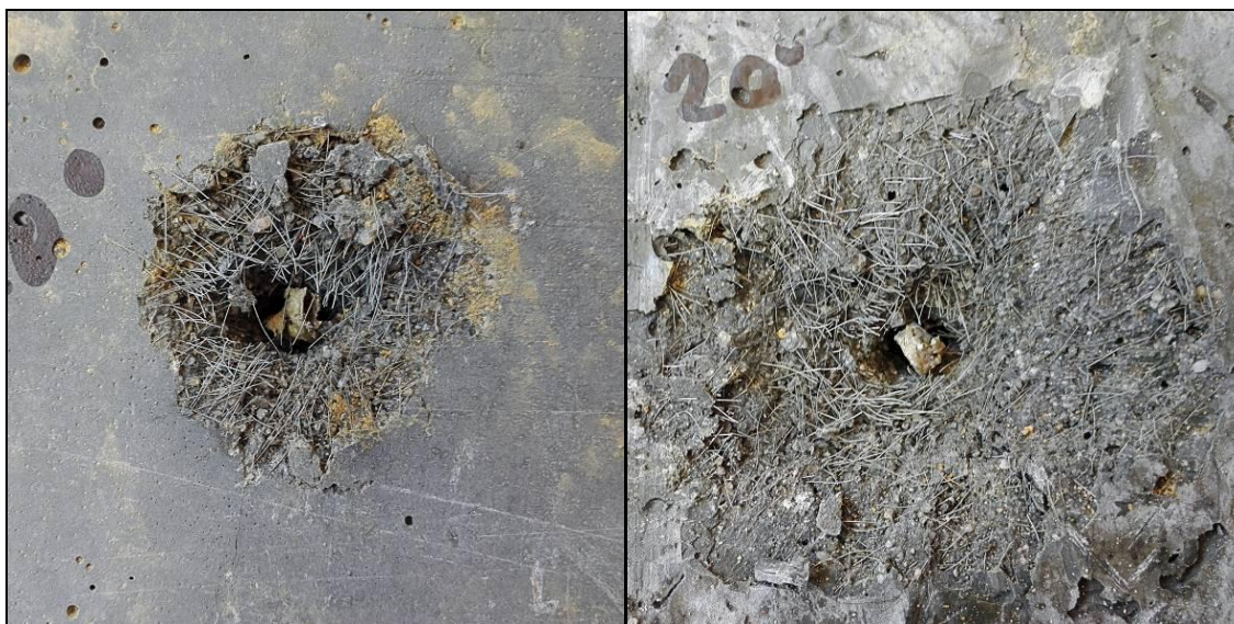
Obrázek 64: Průstřel desky při dopadovém úhlu \beta = 20^\circ
