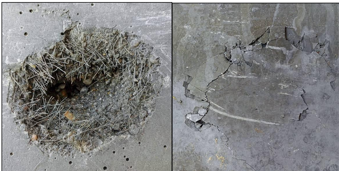
Obrázek 66: Zaražené jádro střely při dopadovém úhlu \beta = 35^\circ
