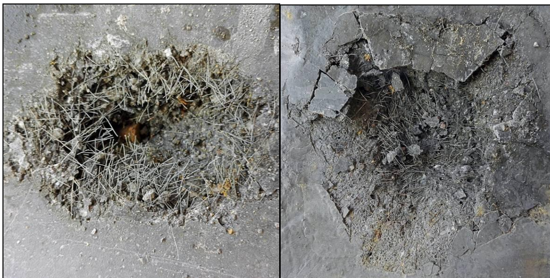
Obrázek 65: Zaražené jádro střely při dopadovém úhlu \beta = 40^\circ
