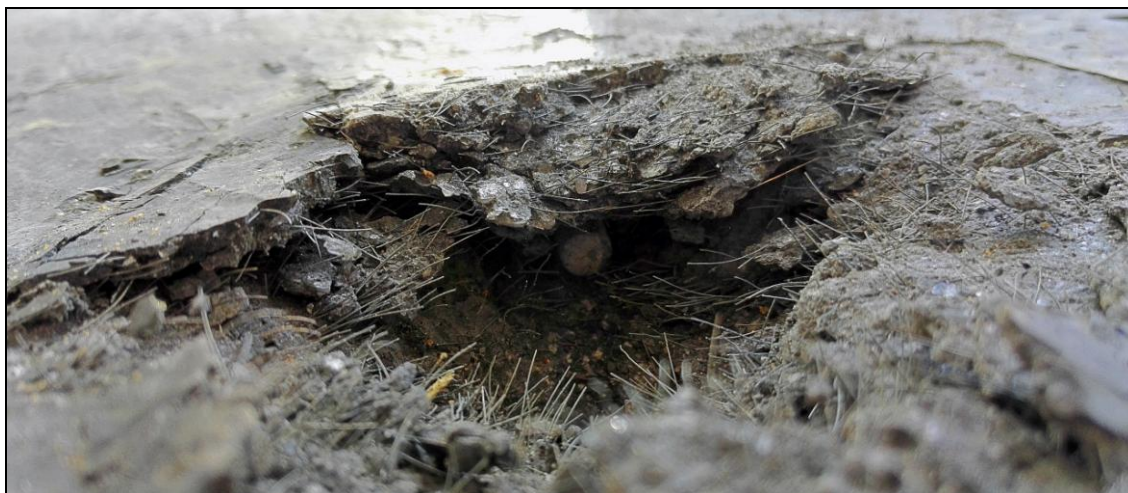
Obrázek 69: Zaražené jádro střely při dopadovém úhlu \beta = 25^\circ
