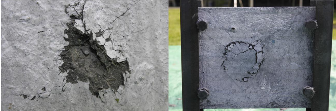
Obrázek 18: Zadní strana desky zasažená střelou 7,62×39 s ocelovým a olověným jádrem [31]
