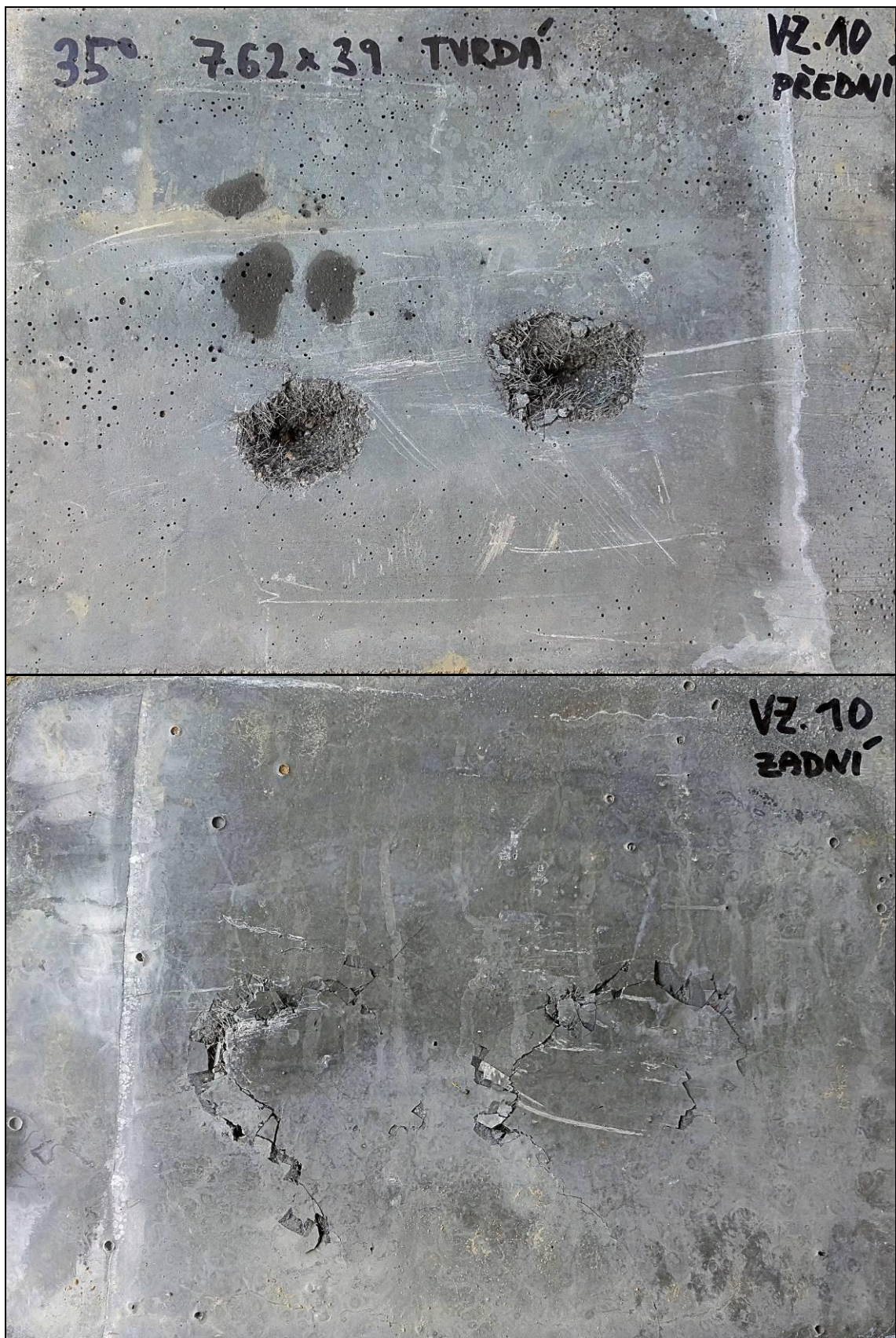
Příloha 6: VZ. 10 - dopadový úhel \beta = 35^\circ
