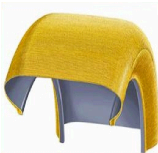
Obr. 4: Vrstva kostry pneumatiky [4]
