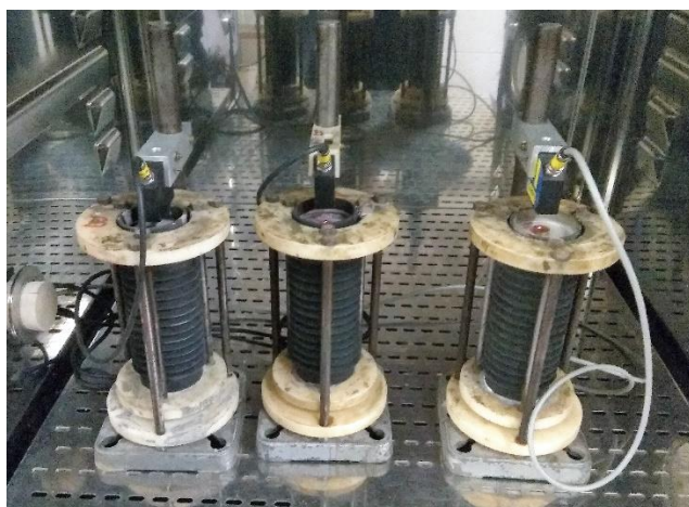
Obr. 1: Aparatura na měření chemického smrštění
