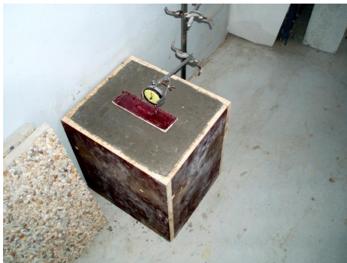
Obr. 2: Měření smrštění na krychli pomocí indikátorových hodiněk [16]
