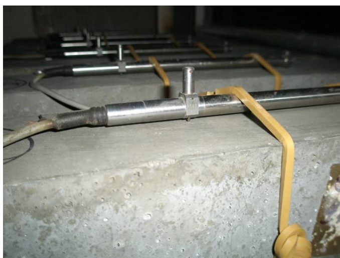
Obr. 3: Měření smrštění pomocí posuvných extenzometrů [16]
