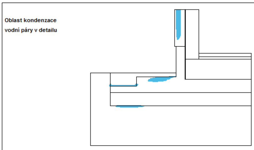
Obr. 26: Oblasti kondenzace vodní páry u desky s konstantním průřezem
