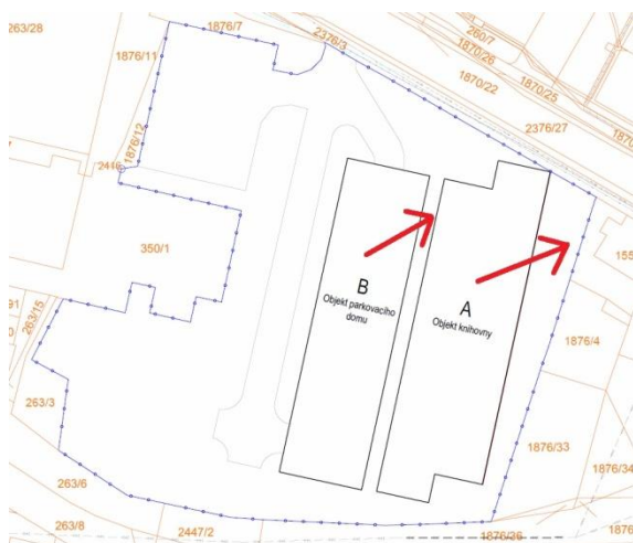
Obrázek 14: Souběžný postup výstavby
