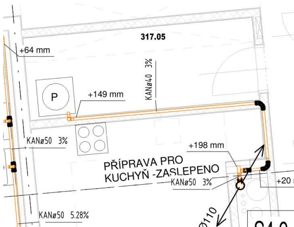
Obr. 1 - Kanalizační potrubí vedené v příčce
