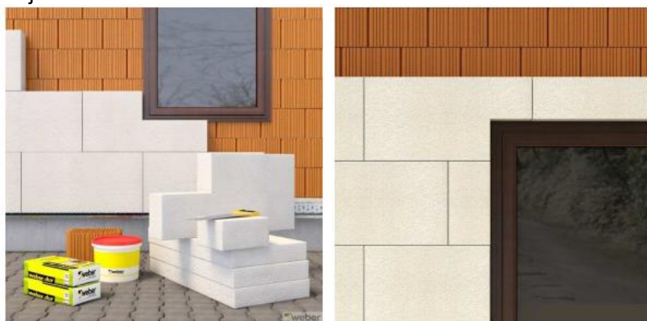
Obrázek 34: Křížení spar desek u otvorů
