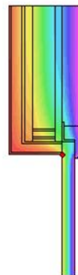
Obrázek 21-Výsledek výpočtu stacionárního pole detailu C
