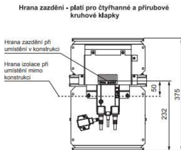
Obr. 1 – Hrana zadržení čtyřhranné klapky PKTM 90-C – Technický list od výrobce Mandík
