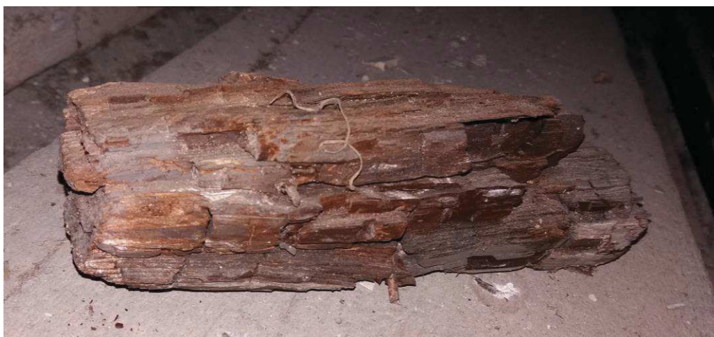
Obrázek 23 - Koskovitý rozpad dřeva, nalezeno během STP
