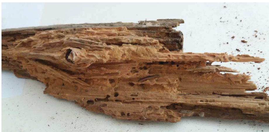
Obrázek 25 - Výletové otvory červotoče a tesaříka – MV 2 a MV 5
