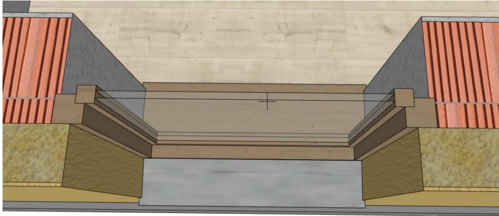
Obrázek 17 - Zalomená omítka okna – 3D
