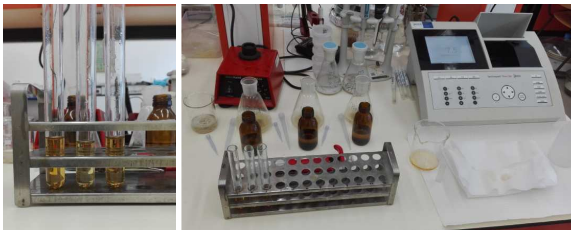
Obr. č. 75.; 76. zbarvení vzorků díky thiokyanátu do slámové žluté; vyhodnocování na fotometru Spectroquant Pharo300 od firmy Merck, která dodává i činidla a postupy testů.
