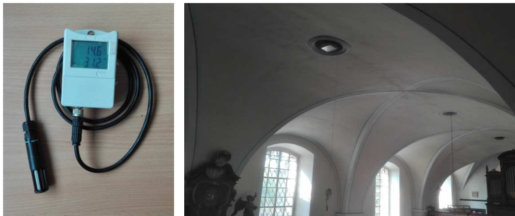
Obr. č. 93.; 94. datový logger Comet; zavěšený logger z prvního stropního otvoru nad oltářem, cca 3,5 m pod stropní klenbou
