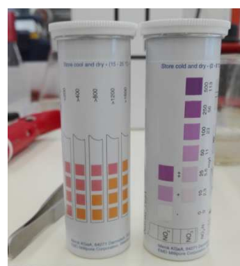
Obr. č. 78.; 79. papírkové testy na obsah síranů a dusičnanů; barevná stupnice k vyhodnocení
