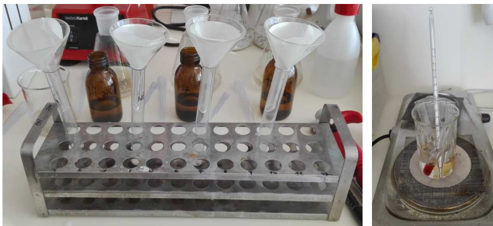
Obr. č. 81; 82. filtrace; druhý ohřev po dobu 7 minut, v čele je vidět vzorek výkvětů s velikým obsahem síranů
