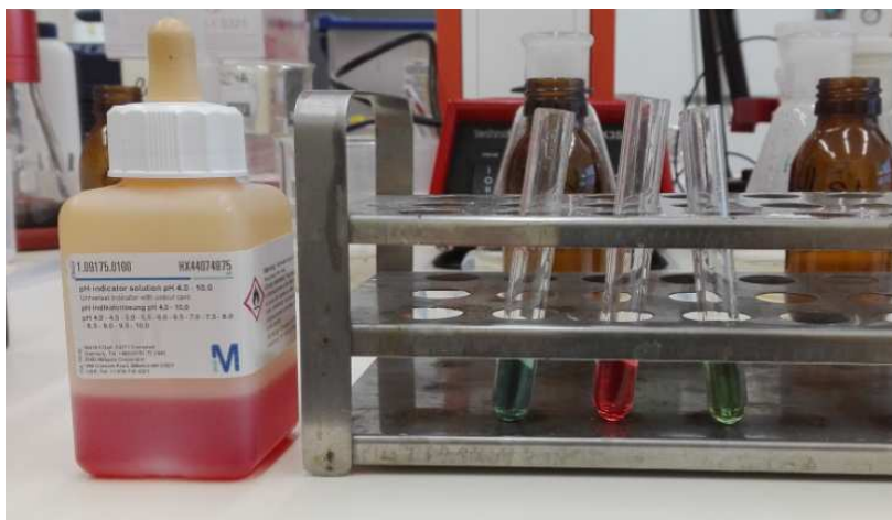
Obr. č. 74. Zabarvení indikátorem pH (zleva vzorek 3, 2 a 1)
