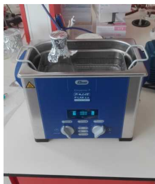
Obr. č. 71.; 72. zahřátí roztoku destilované vody a vzorku; rozbíjení hrudek materiálu ultrazvukem
