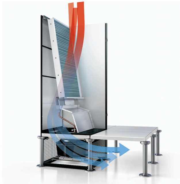
Obrázek 7: Proudění vzduchu v sálové CRAC jednotce [20]
