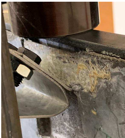
Obr. 71: Vznik první trhliny
