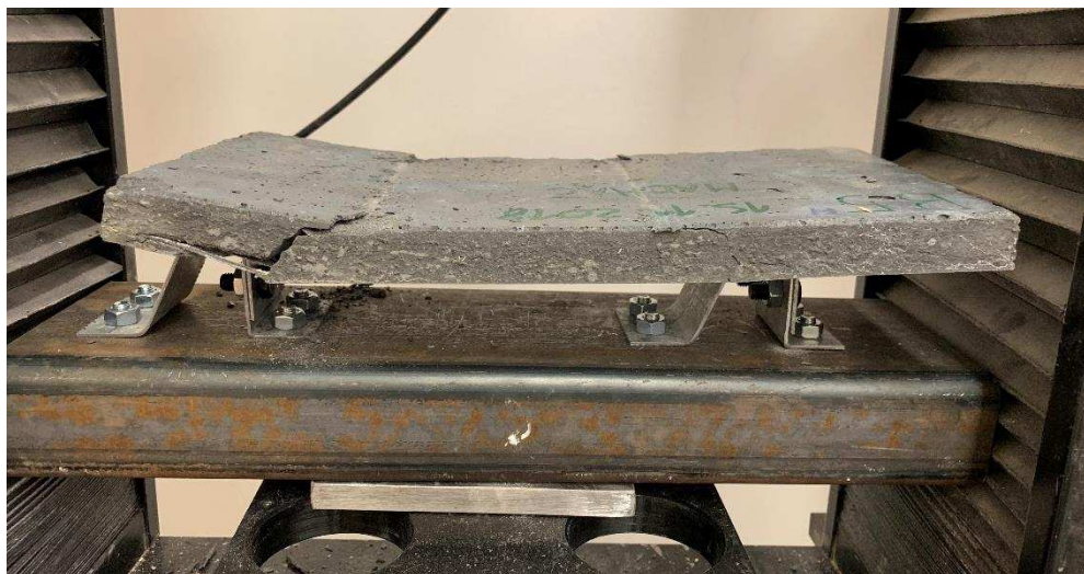
Obr. 96: Fasádní deska po kolapsu a odlehčení.
