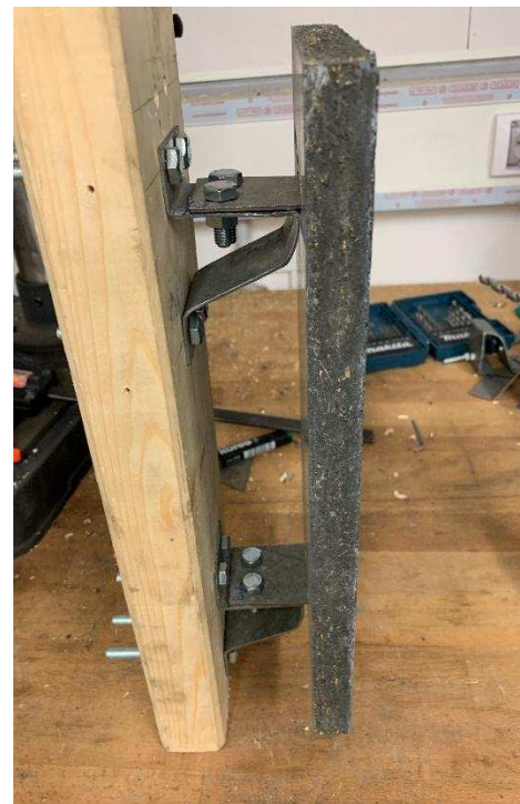
Obr. 63: Test zavěšení desky na kotvení
