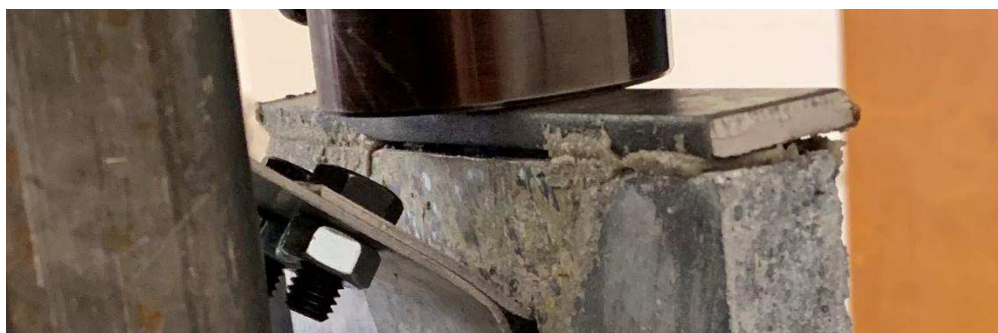
Obr. 67: Dosednutí hlavy lisu na roznášecí ocelový pásek
