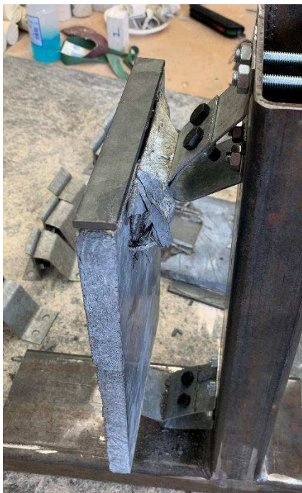
Obr. 73: Kotvení po ukončení zatěžování
