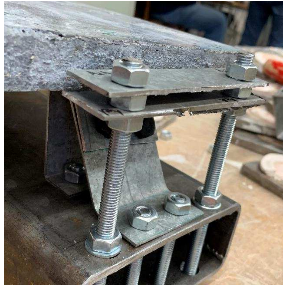
Obr. 85: Systém simulující napojení horní desky
