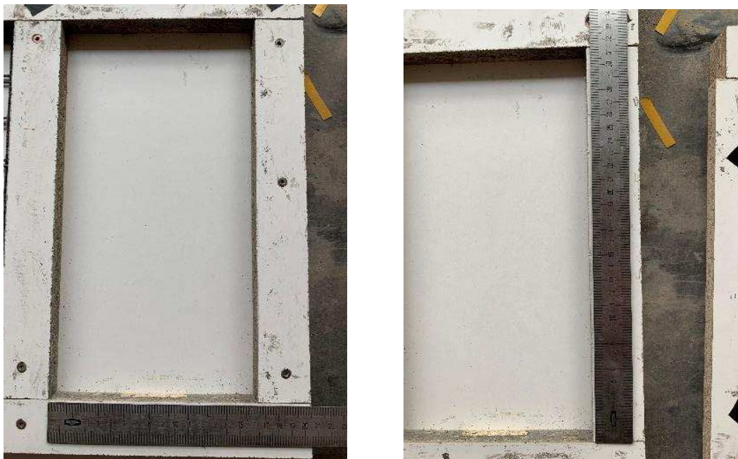
Obr. 30: Bednění jednoho výseku desky s vyznačením rozměrů
