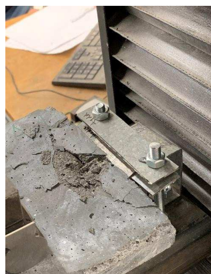
Obr. 90: Rozvoj trhlin v pokročilém stádiu
