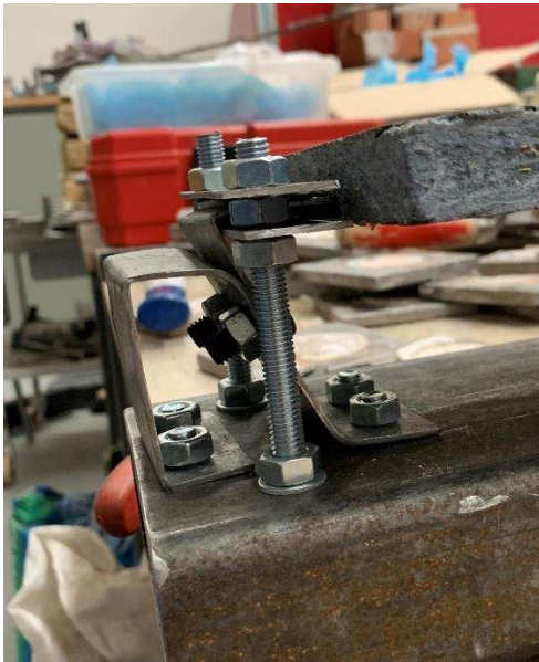
Obr. 84: Systém simulující napojení spodní desky
