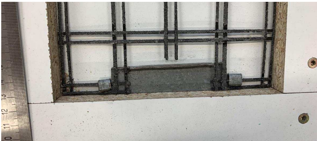
Obr. 33: Zabetonovaný kotevní prvek ve spodní části desky
