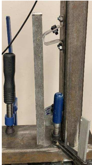
Obr. 81: Kotvení po odlehčení
