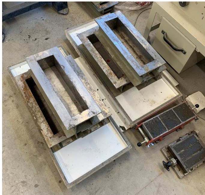
Obr. 42: Zatížené desky a vybetonované trámce a krychle
