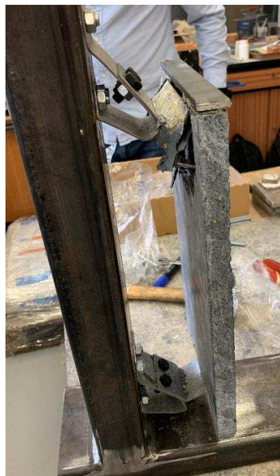
Obr. 74: Kotvení po ukončení zatěžování
