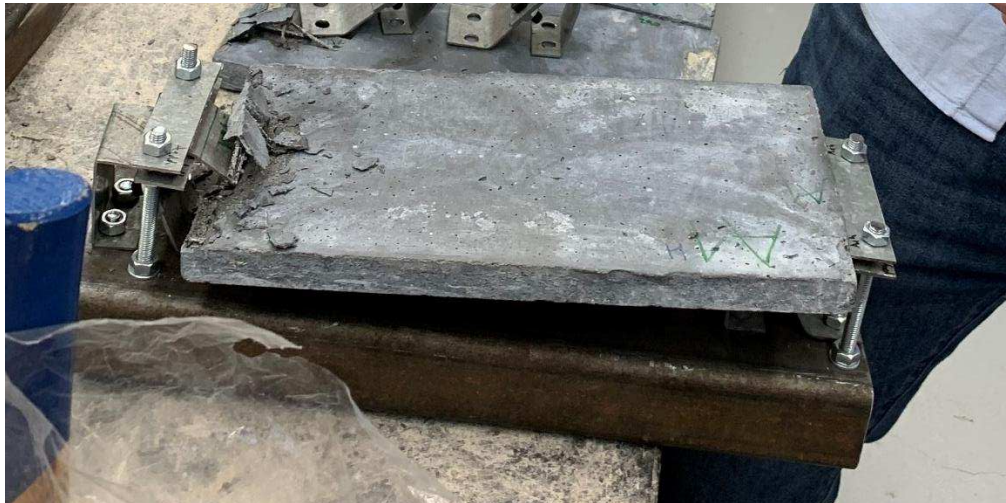
Obr. 91: Deska po ukončení zatěžování – Varianta A
