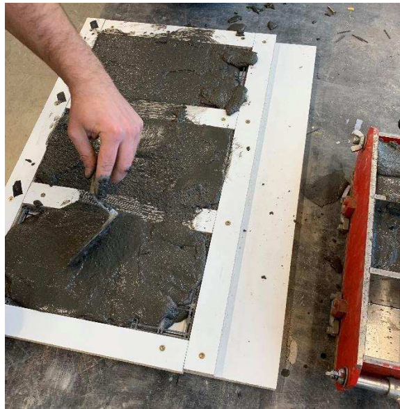
Obr. 41: Aplikace betonové směsi do bedně
