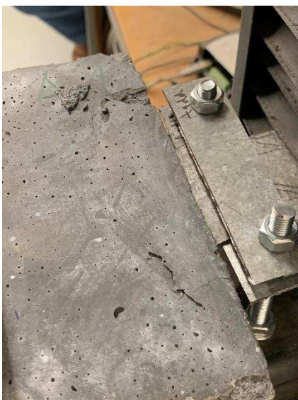
Obr. 89: Rozvoj trhlin vytlačováním betonu
