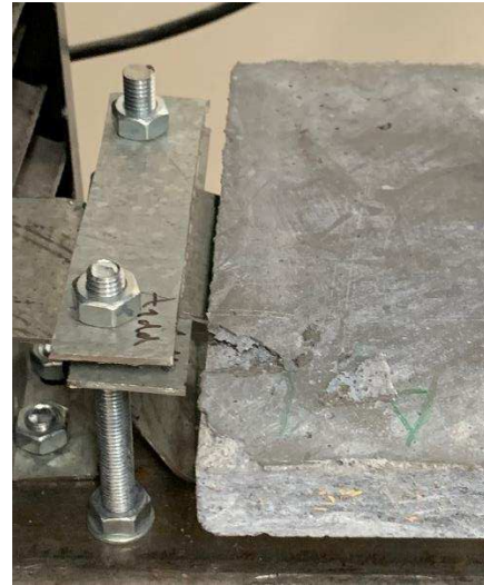
Obr. 88: Vznik první trhliny v desce
