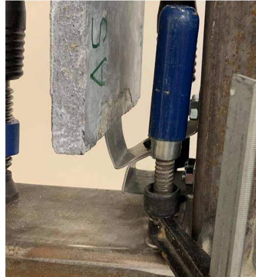
Obr. 70: Deformace spodní kotvy
