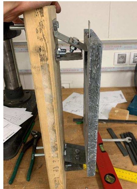
Obr. 57: Test zavěšení desky na kotvení
