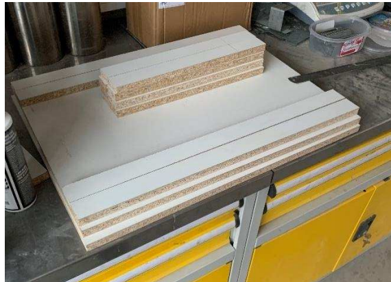
Obr. 29: Nařezané kusy lamina pro přípravu bednění
