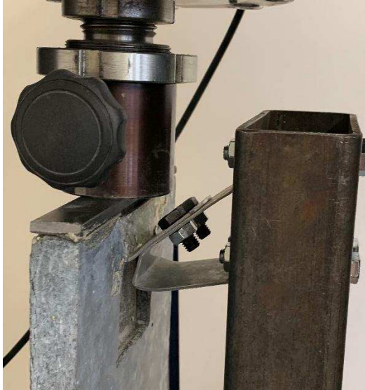
Obr. 69: Deformace horní kotvy
