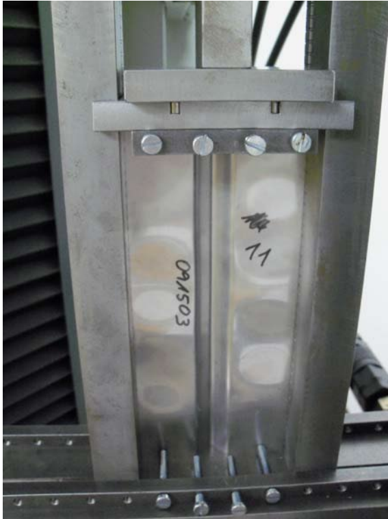
Obrázek 9: Lokální boulení pásnice s úzkým žlábkem [7]
