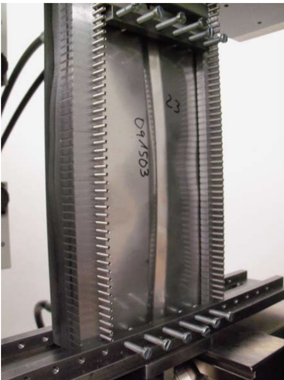
Obrázek 11: Distorzní vyboulení pásnice s úzkým žlábkem [7]
