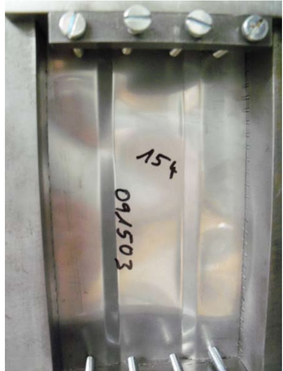
Obrázek 10: Lokální boulení pásnice se širokým žlábkem [7]
