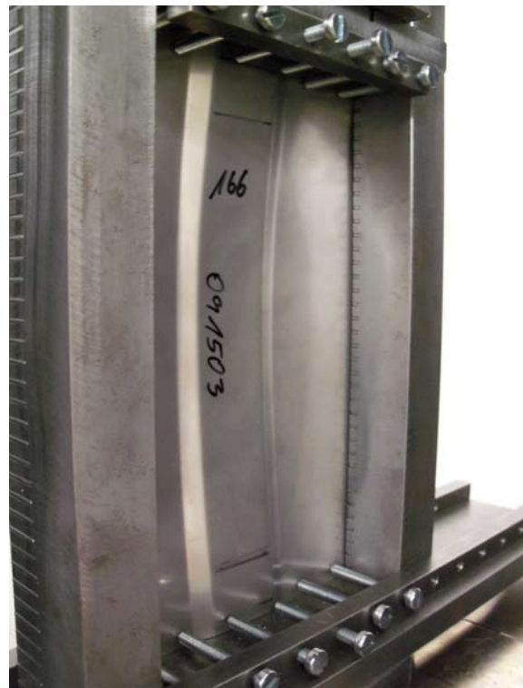
Obrázek 12: Distorzní vyboulení pásnice se širokým žlábkem [7]
