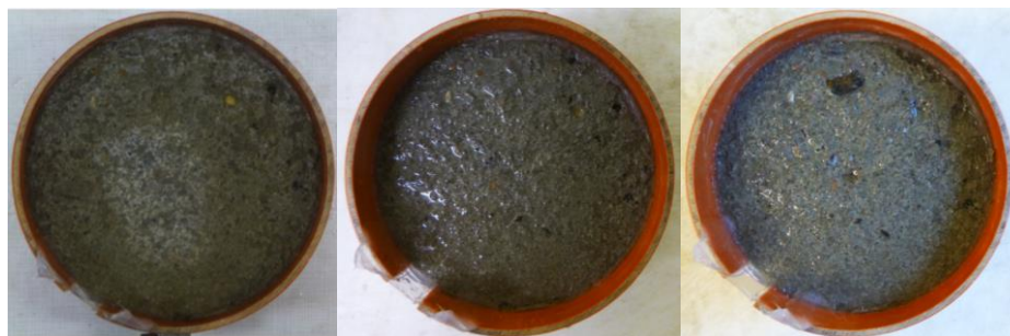
Obr. 82- Ukázky povrchů (hlazený), metoda C, receptura: PZ39B-S50
