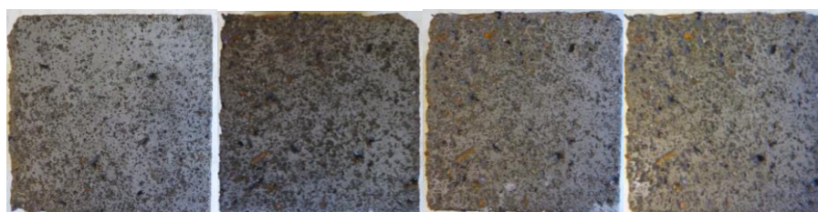
Obr. 104- Ukázky povrchů (bok), metoda A, receptura: PZ39B-O50
