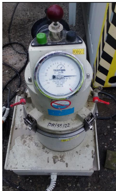
Obr. 13- Zkouška obsahu vzduchu v čerstvém betonu-detail
