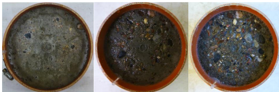
Obr. 81- Ukázky povrchů (dno), metoda C, receptura: PZ34B-O50
