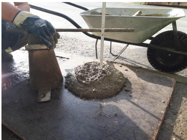
Obr. 67- Zkouška sednutí kužele, receptura: PZ34B-O50
