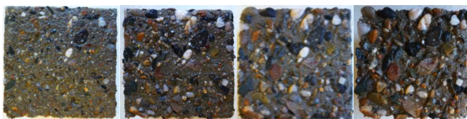
Obr. 95- Ukázky povrchů (bok), metoda A, receptura: PZ34B-S50
