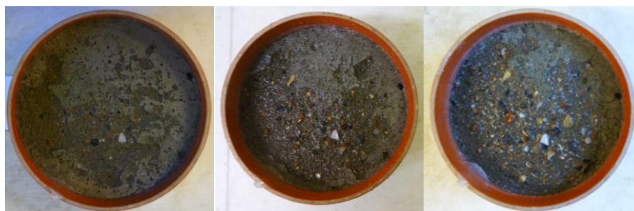
Obr. 76- Ukázky povrchů (hlazený), metoda C, receptura: PZ34B-S50
