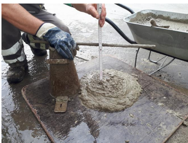
Obr. 69- Zkouška sednutí kužele, receptura: PZ39B-O50
