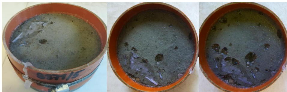
Obr. 74- Ukázky povrchů (hlazený), metoda C, receptura: PZ39A-S45
