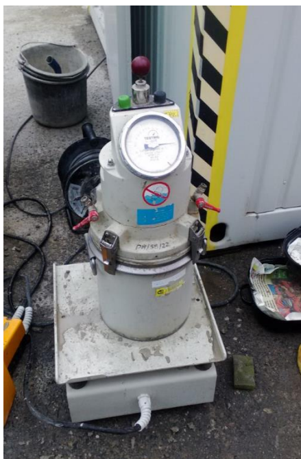
Obr. 12- Zkouška obsahu vzduchu v čerstvém betonu
