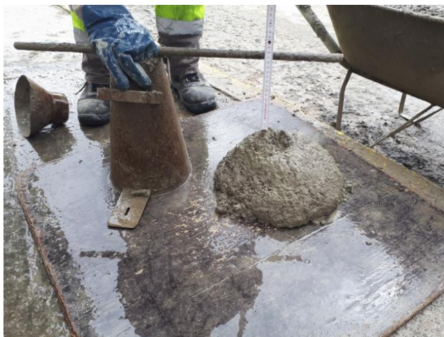
Obr. 64- Zkouška sednutí kužele, receptura: PZ39A-S45
