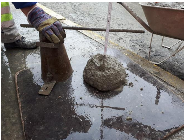
Obr. 61- Zkouška sednutí kužele, receptura: PZ38C-O52
