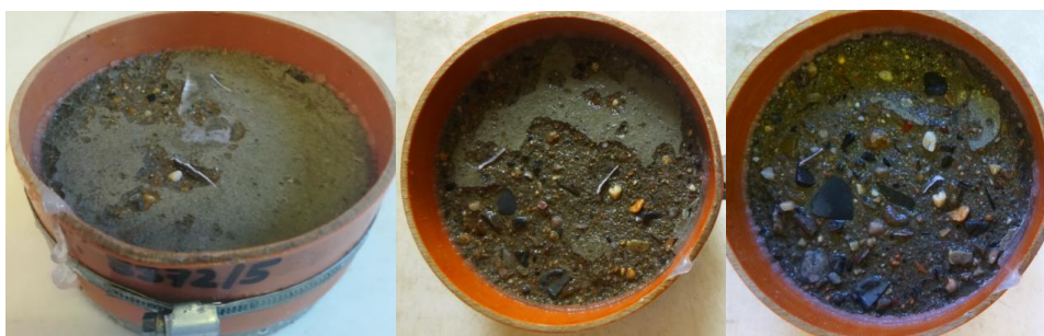
Obr. 75- Ukázky povrchů (hlazený), metoda C, receptura: PZ39A-S50
