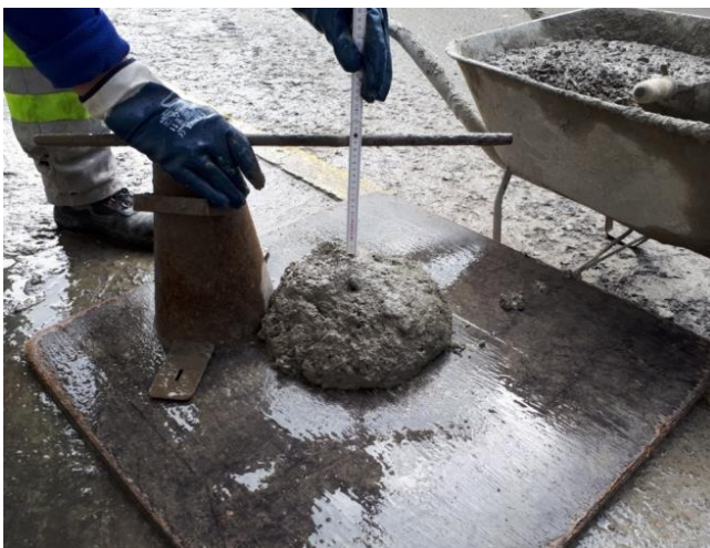
Obr. 62- Zkouška sednutí kužele, receptura: PZ34A-S45
