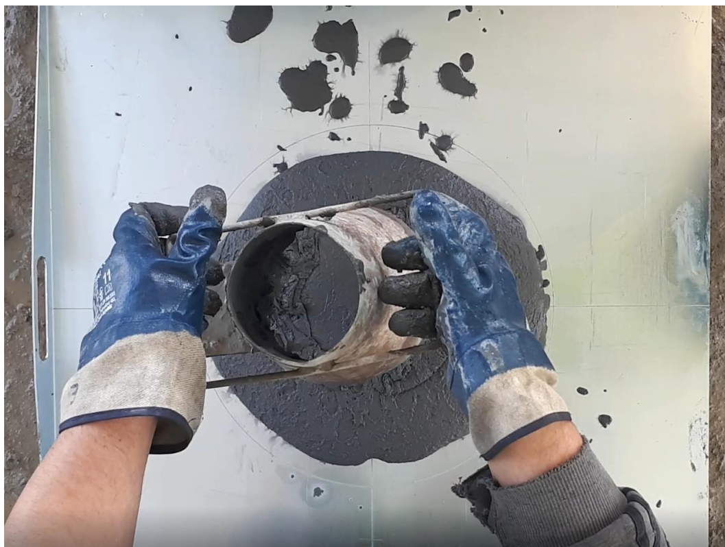
Obr. 56- Měření konzistence rozlitím kužele a času T 500
