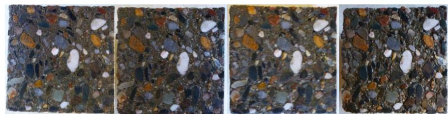
Obr. 97- Ukázky povrchů (řez), metoda A, receptura: PZ34B-O50
