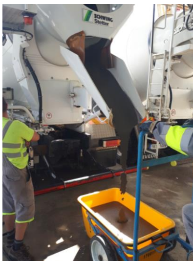
Obr. 55- Odebírání betonu s nízkou porozitou z autodomíchávače
