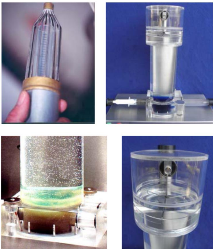
Obr. 25- AVA: Odebrání vzorku, aparatura, měření [34]
