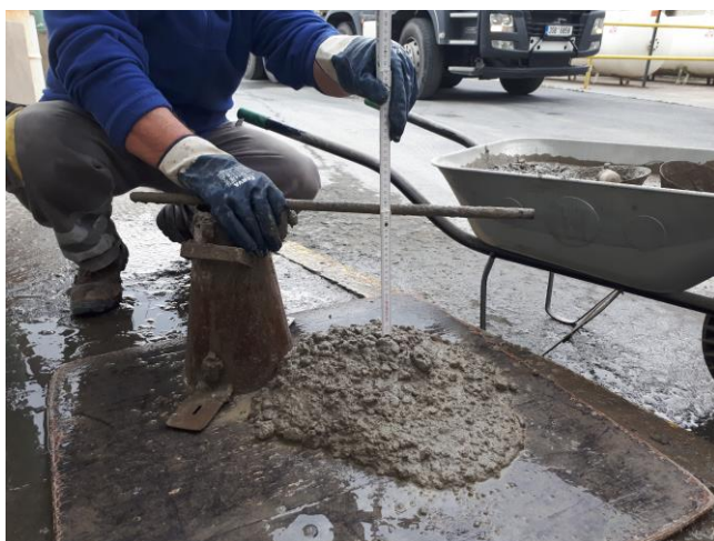
Obr. 66- Zkouška sednutí kužele, receptura: PZ34B-S50
