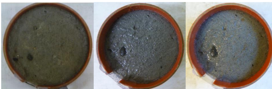
Obr. 85- Ukázky povrchů (hlazený), metoda C, receptura: PZ39B-O50
