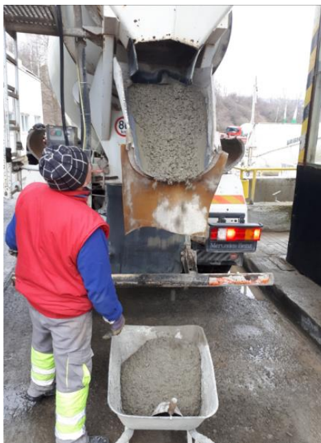
Obr. 18- Odebírání betonu pro výrobu vzorků
