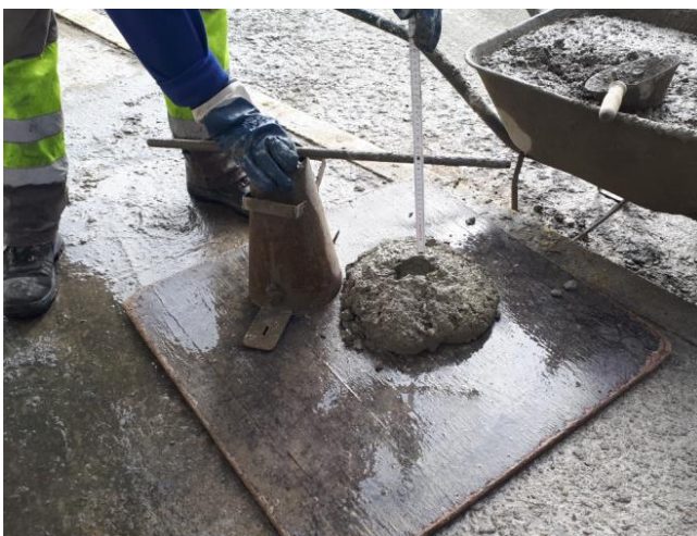
Obr. 63- Zkouška sednutí kužele, receptura: PZ34A-S50
