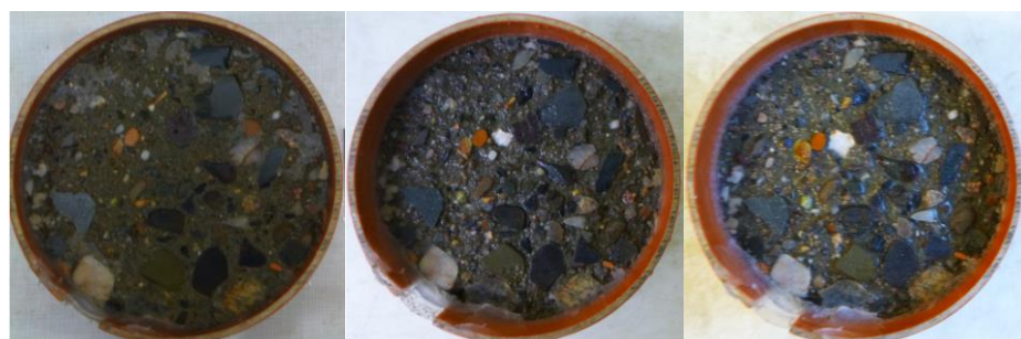
Obr. 83- Ukázky povrchů (řez), metoda C, receptura: PZ39B-S50
