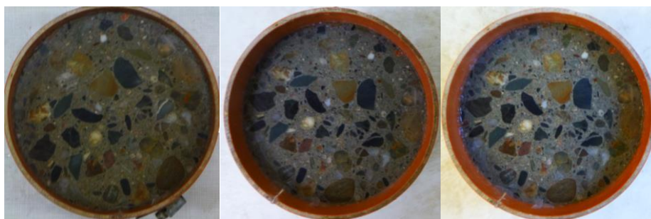
Obr. 86- Ukázky povrchů (řez), metoda C, receptura: PZ39B-O50
