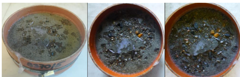
Obr. 73- Ukázky povrchů (hlazený), metoda C, receptura: PZ34A-S50
