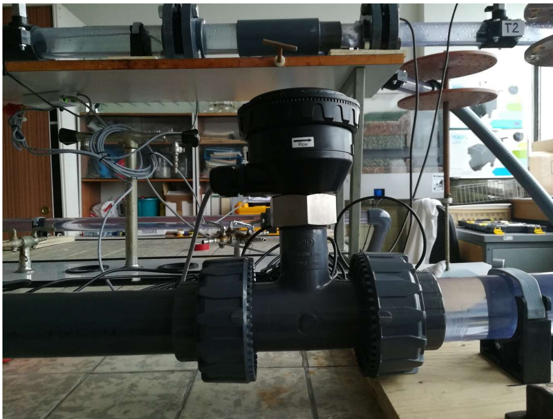
Obrázek 5.9 – Zapojení indukčního průtokoměru FLS F6.60
