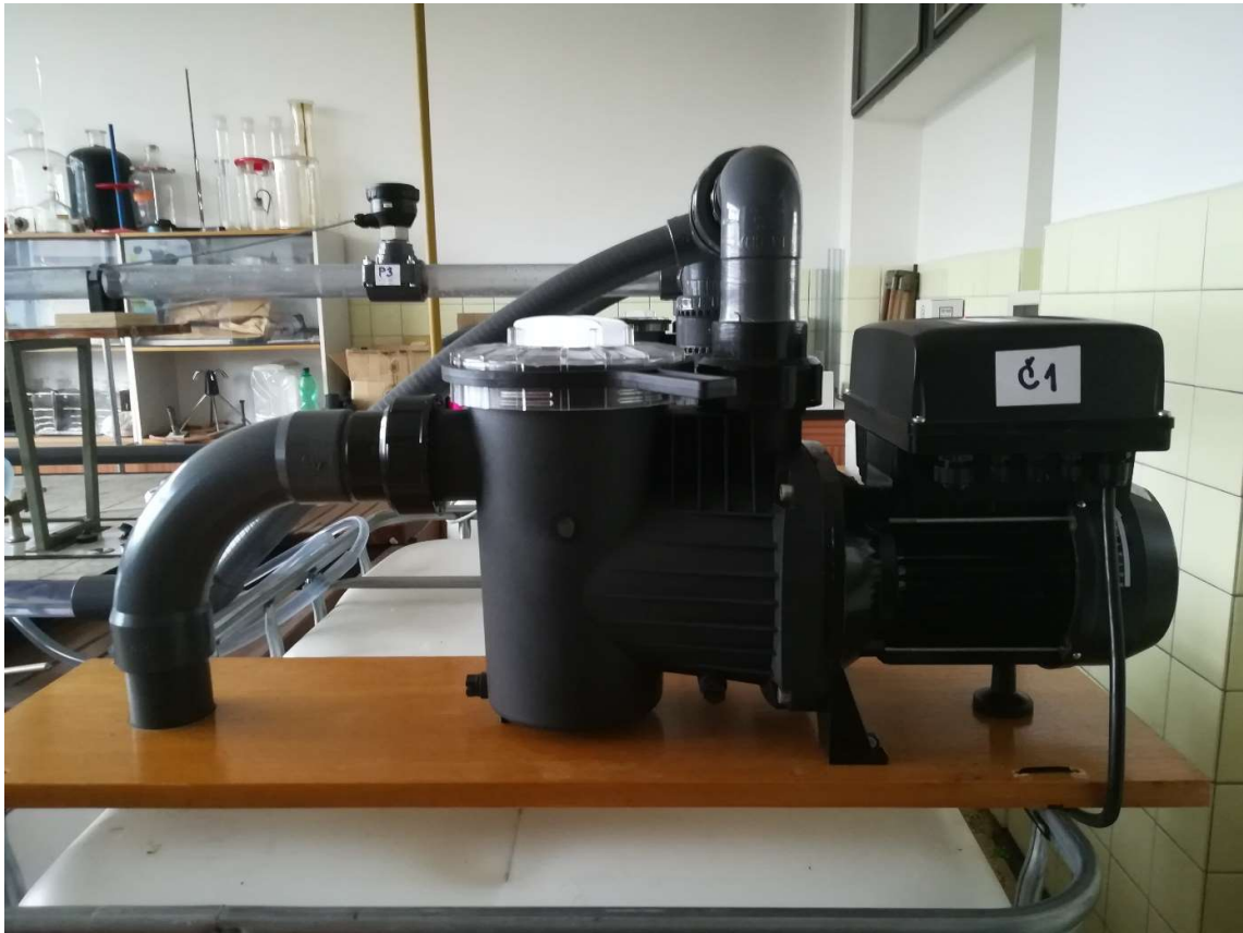
Obrázek 5.4 – Čerpadlo [e] Winner 300 M
