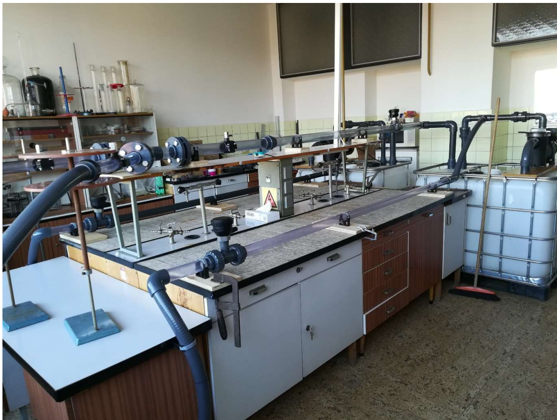
Obrázek 5.6 – Transparentní potrubí PVC 50x2,4 mm a PVC 63x3,0 mm
