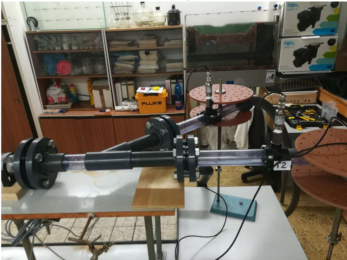
Obrázek 5.8 – Příklad zapojení T-kusu 45°
