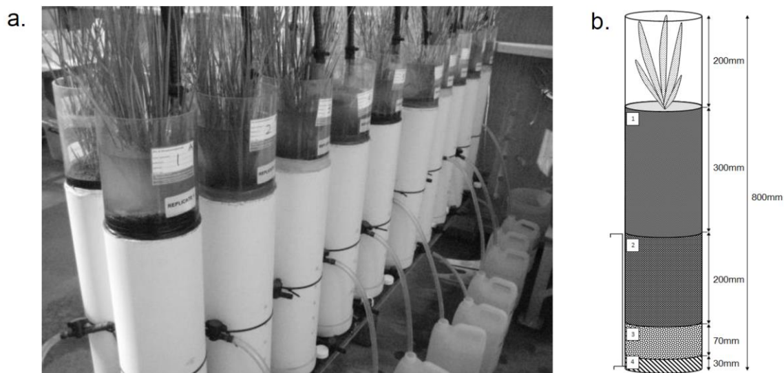
Obr. 7 – (a) Experimentální sestava zařízení ve skleníku, (b) Schematický diagram válců biofiltru (s připojenou stoupající větví odtoku pro saturovanou zónou) [32]
