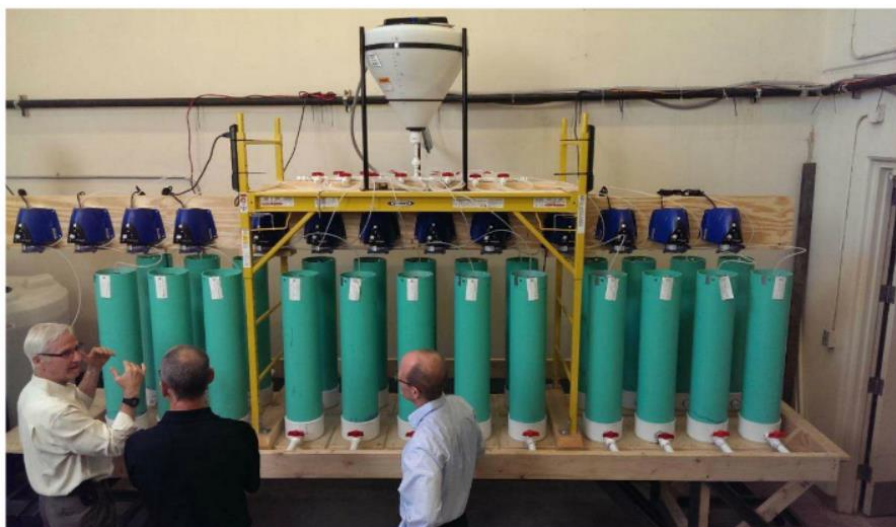
Obr. 6 – Sestava válců s distribuční nádrží a peristaltickými čerpadly [43]
