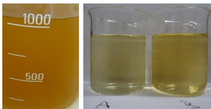
Obr. 25 – Barva odtoku ze vsakovací zkoušky (vlevo) a ze zimního experimentu č. 29 (vpravo)
