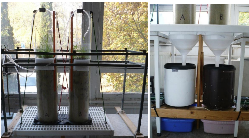
Obr. 10 – Válc s přítokovými hadičkami v konstrukci (vlevo) a odtok z válců (vpravo)
