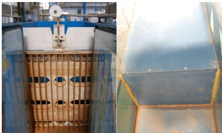
Obrázek 7 Regulace odtoku (vlevo) , uchytení široké koruny ve žlabu (vpravo)
