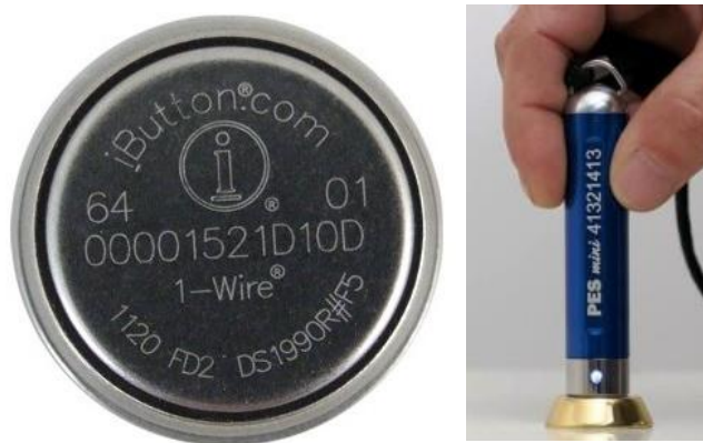
Obrázek 10: Čip iButton s ukázkou zápisu dat do PES Mini
